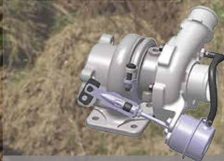
**Turbolader mit Ladedruck-Regelventil:** Leitet Abgase vom Turbinenrad weg, um den Ladedruck optimal zu regeln und den Motor zu schützen. So kann der Turbolader schneller das maximale Drehmoment erzeugen und unterliegt bei hohen Drehzahlen und geringer Belastung einem geringeren Verschleiß. Turbolader erhöhen die Luftdichte, so dass der Motor ungeachtet der Standorthöhe (ü. NN.) mehr Leistung erzeugt.
