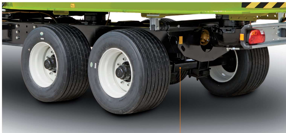
Neue Bogieachse, auch mit Nachlauflenkung erhältlich, bei Dunker T2S und T2L Nouveau bogie, disponible aussi en version autodirectrice, sur les dunker T2S comme les T2L Nieuwe bogie, verkrijgbaar ook in zelfsturende versie, zowel op dunker T2S als op T2L
