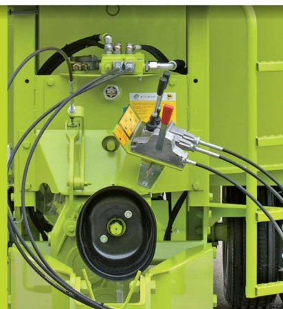
Zweistufiges Schaltgetriebe auch mit Bowdenzugbedienung erhältlich (Zubehör)
