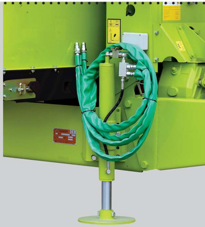
Hydraulischer Stützfuß mit direktem Traktoranschluß Béquille à commande électrique branchée au système hydraulique du tracteur Hydraulische steunpoot aangesloten op tractor hydrauliek
