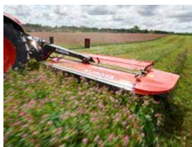
Midden-ophanging voor gelijkmatige gewichtsverdeling over de hele werkbreedte.
