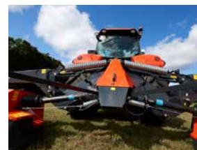
Sterke compensatieveren zorgen voor gelijkmatige bodemdruk over gehele breedte van de maaier.
