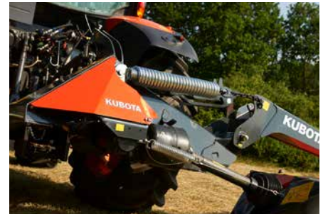
Le ressort de grand diamètre assure une excellente flottaison sur toute la largeur de la faucheuse.
