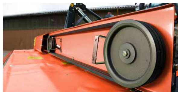
En inversant le sens des poulies, il est possible d'entraîner la faucheuse en 750 ou 1000tr/min.
