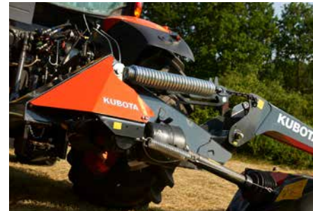
Große Entlastungsfedern garantieren immer eine optimale Bodendruckentlastung mit perfekter Bodenadaptation.
