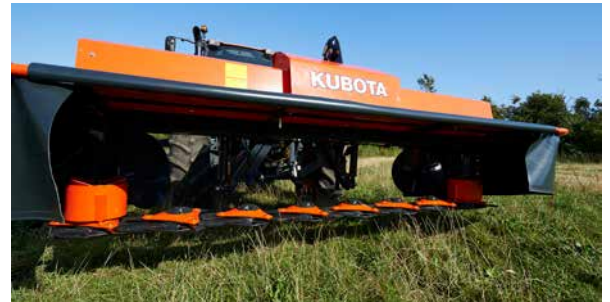
Optimaler Zugang zum Mähbalken durch klappbaren Front- und Seitenschutz.
