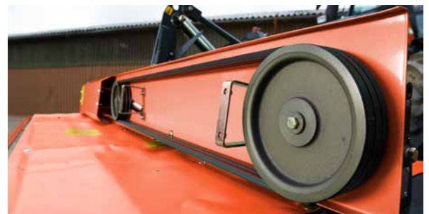
Durch Wechseln der Riemenscheiben kann das DM4000 mit 750 U/min gefahren werden. Dies spart Kraftstoff.
