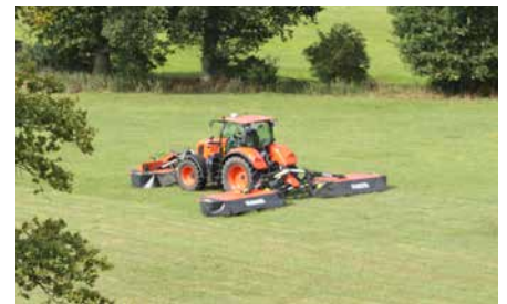
Die Mittenaufhängung garantiert einen gleichmäßigen Auflagedruck.
