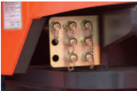
Hydraulische bedieningselementen De drukregelkleppen zijn gegroepeerd (hoofddruk, stuurdruk, remdruk).
