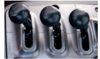
Control preciso Control de 3 palancas para el brazo de elevación, el cucharón y el tercer circuito. El interruptor FNR cambia la dirección de desplazamiento y los modos de reducción de marcha, volver a excavar, desconexión de la elevación del brazo y de flotación.
