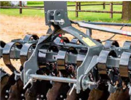
Dreipunktaufnahme Kat. II inkl. Schnellkupplerstange für ein schnelles An- und Abkuppeln der Maschine an den Schlepper.
