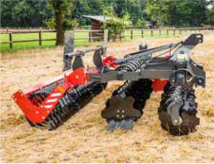
Der kompakte und besonders robuste Rahmenaufbau hält auch den schwersten Einsatzbedingungen stand. Der Balkenabstand von 800 mm garantiert zudem ein verstopfungsfreies Arbeiten.
