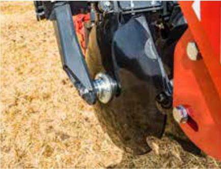
Die gezackten Hohlkreise mit einem Durchmesser von 560 mm sind an staubdichten und wartungsfreien Qualitätslagern mit einer besonders langen Lebensdauer montiert. Aufgrund der Scheibenstellung ohne Untergriff (Non-Angle) werden hohe Arbeitsqualitäten mit minimalem Scheibenverschleiß kombiniert.
