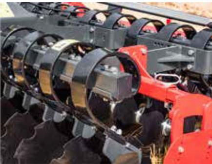
Die Blattfederelemente garantieren einen größtmöglichen Ausweichwinkel der Scheiben und dienen als automatische Überlastsicherung. Dadurch können die Scheiben problemlos tiefe Fahrspuren und Unebenheiten bearbeiten. Besonders geeignet für extrem steinige Böden.
