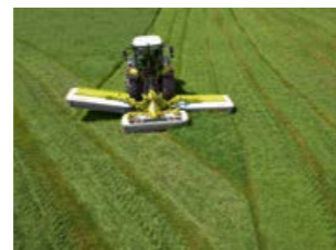
Relevage individuel des unités de fauche en fourrière.
