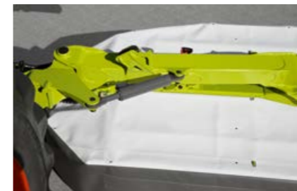
Protection assurée par la sécurité anticollision hydraulique non-stop en cas de choc – l'unité de fauche pivote et se remet automatiquement dans la position initiale.
