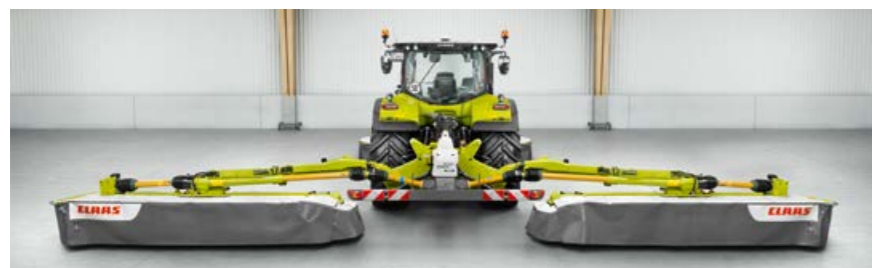
Deux bras télescopiques à commande hydraulique réglables en continu pour un recouvrement optimal sur la DISCO 1100 TREND.
