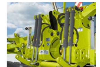
Les vérins de suspension et de relevage montés de série pour l'ACTIVE FLOAT ménagent la couche végétale.
