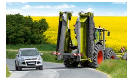
Moins de 4 m : encombrement réduit en position de transport, avec une garde au sol généreuse sur les deux modèles BUSINESS.
