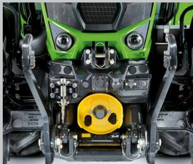
Nouvelle commande de position du relevage avant (modèles TTV) avec puissance de levage maximale de 5 480 kg.
