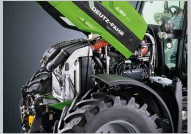
Système de refroidissement hautement efficace et compact avec intercooler, moteur, transmission, refroidisseur de carburant et condenseur de climatisation.
