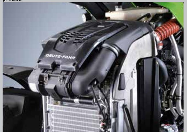
Filtre à air à technologie PowerCore : débit d'air 20% supérieur à celui des filtres standards comparables.
