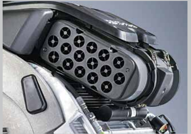
Système de pré-nettoyage du filtre à air : les tuyaux en spirale et le tuyau aspirateur éliminent 95 % des poussières avant qu'elles n'atteignent le filtre primaire.
