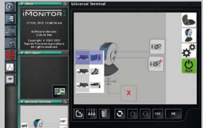
Intégration ISOBUS. Fonctions de l'outil contrôlées via touches définies du tracteur.
