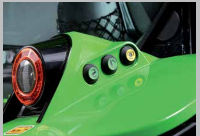
Mandos de elevador trasero y toma de fuerza exteriores para un manejo y conexión sencillas de los implementos.
