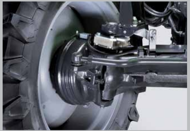
Un concepto de seguridad único de DEUTZ-FAHR. Discos de freno separados refrigerados por aceite en las ruedas delanteras.
