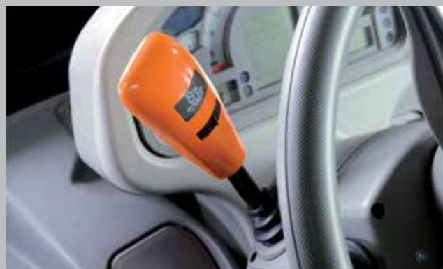
Inversor hidráulico de serie. Inversor electrohidráulico con regulación de cinco etapas
