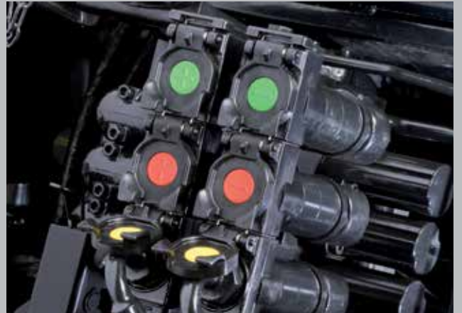
Los nuevos distribuidores hidráulicos de elevado caudal con un rendimiento superior.
