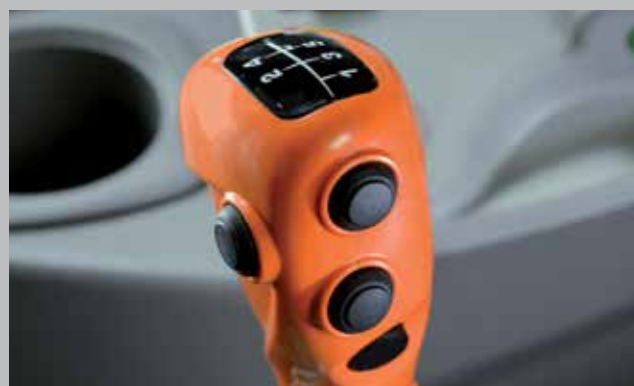
Comfort Clutch y Powershift. Cambie de marcha simplemente pulsando un botón, sin pisar el pedal del embrague.
