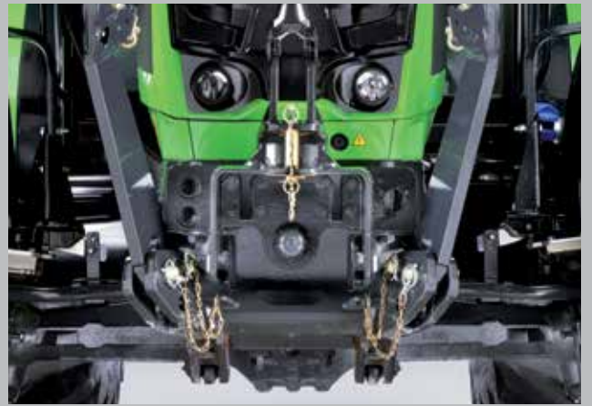
Elevador delantero. Capacidad de elevación de 2100 kg y TDF 1000.
