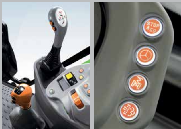
Joystick de cargador frontal con botones de Powershift. Stop&Go, sistema de dirección rápida SDD...
