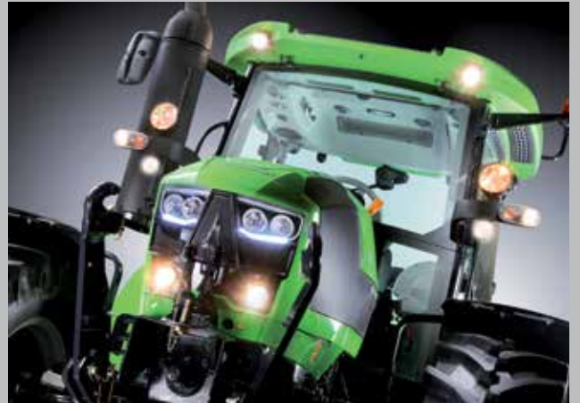
El equipo de luces. Para una visibilidad óptima cuando la visibilidad es escasa. Ocho faros de trabajo en el techo y en los montantes laterales. Dos faros de trabajo y dos luces de led en el capó.
