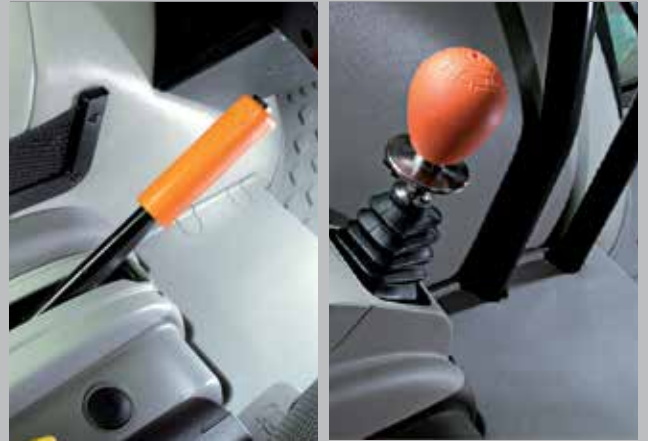
Freno de estacionamiento mecánico o hidráulico. La elección es suya.
