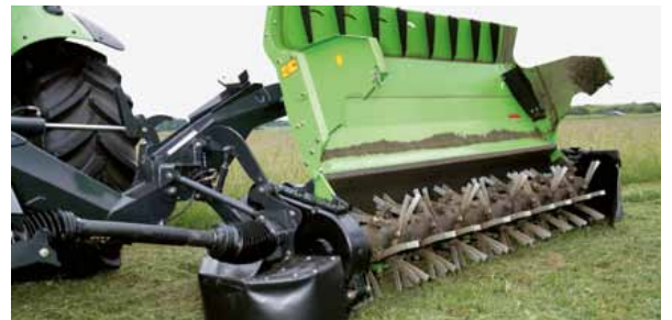
Das gesamte Heck des Mähers kann für einfachen Zugang zum Aufbereiter angehoben werden.
