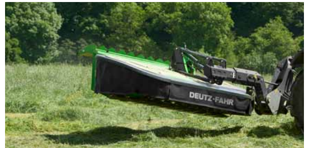
Min. 500 mm Aushubhöhe am Vorgewende. Die Mäheinheit wird über die QuattroLink Mähwerksaufhängung ausgehoben und dann der Auslegearm um 10° angehoben.
