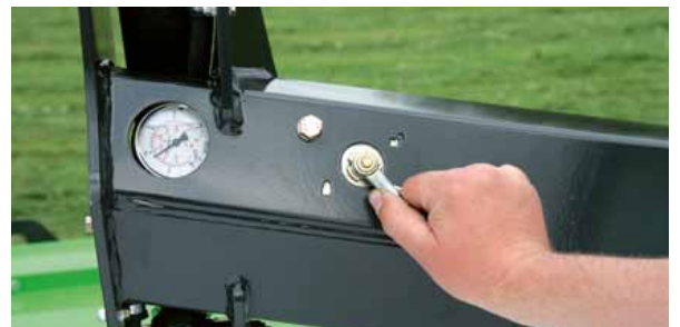
Hydraulische Aufhängung für einfache und präzise Einstellung des Bodendrucks.
