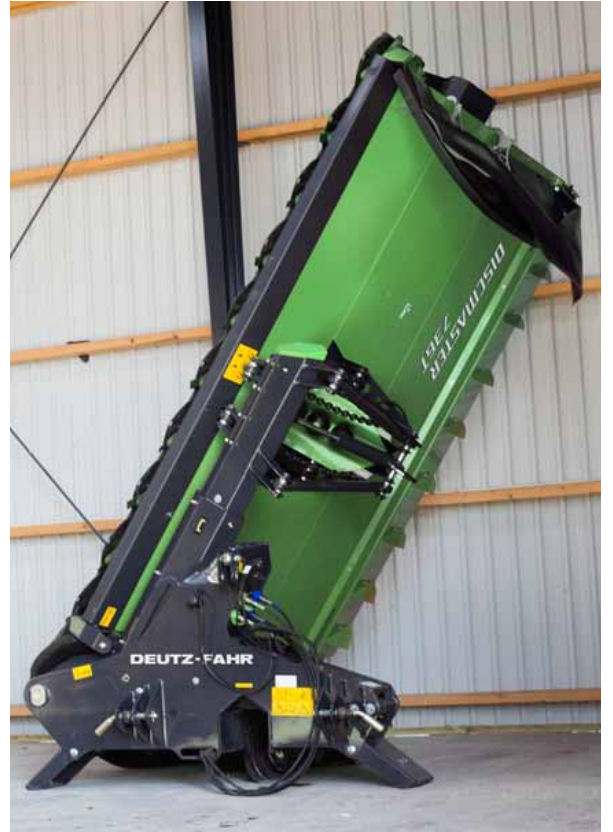
Egal ob das Mähwerk in der vertikalen oder altbekannten horizontalen Position abgestellt worden ist, der An- und Abbau ist sehr einfach da die Unterlenkeranbaupunkte immer stabil in einer waagerechten Position stehen.
