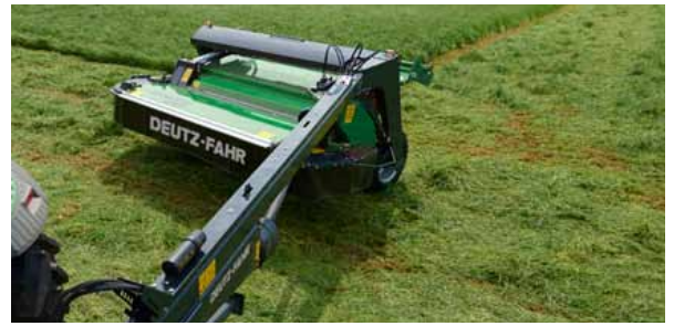
Der Schwenkdeichselkopf mit Umkehrgetriebe sorgt für optimale Wendigkeit.
