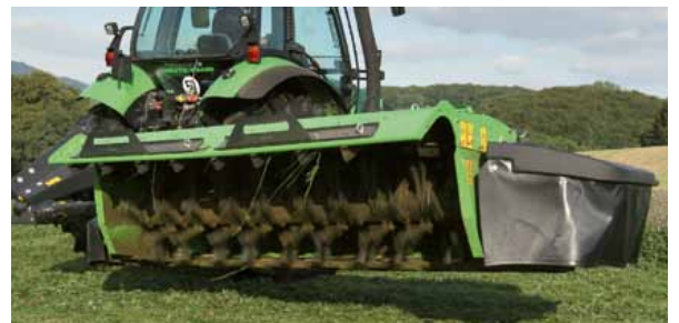
Einfaches Anheben am Vorgewende ohne Betätigung der Dreipunkthydraulik am Schlepper.
