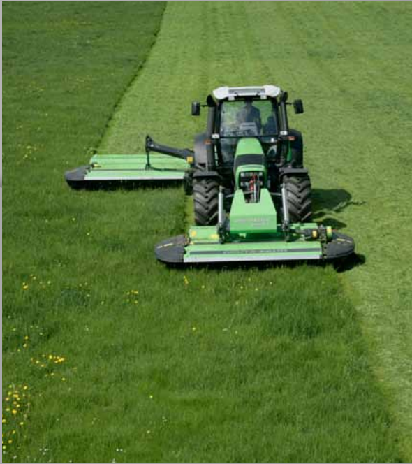
Mähkombination mit einer Arbeitsbreite von 6,20 m.
