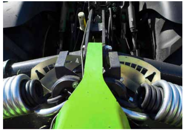
Die Bodendruckentlastung wird über zwei Spiralfedern eingestellt - optional ist eine eine hydraulische Einstellung erhältlich.
