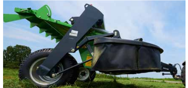
Dank 50 cm Aushubhöhe können Schwade am Vorgewende ohne Probleme überfahren werden.
