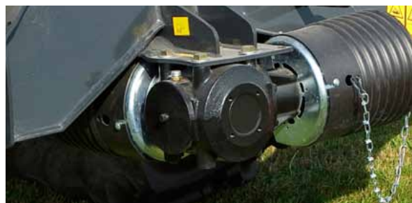
Einstellbare Getriebedrehzahl durch Drehen des Getriebes.
