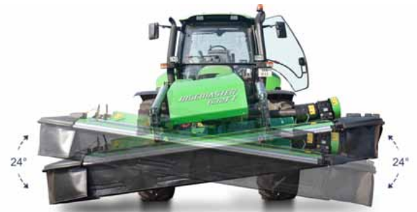
Die innovative Aufhängung ermöglicht eine Queranpassung von 24°.
