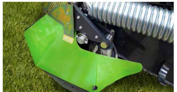
Réglage hydraulique de la pression au sol.
