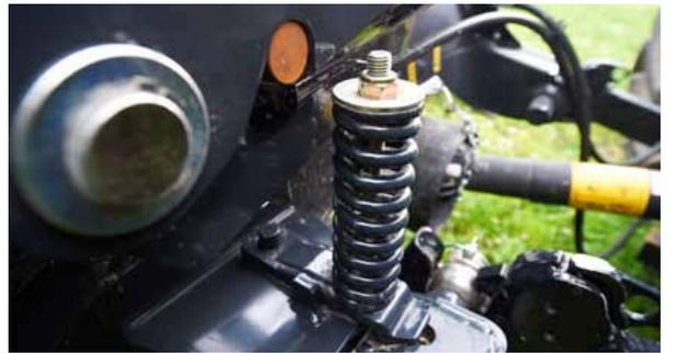
En cas d'obstacle le dispositif de sécurité Non-Stop protège le lamier en reculant.
