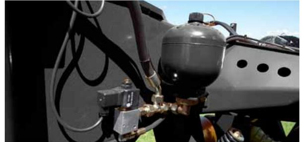
La suspension hydraulique assure un réglage précis de la pression au sol (DiscMaster 440H).
