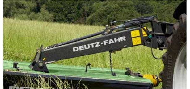
Un vérin hydraulique pour un relevage facilité.
