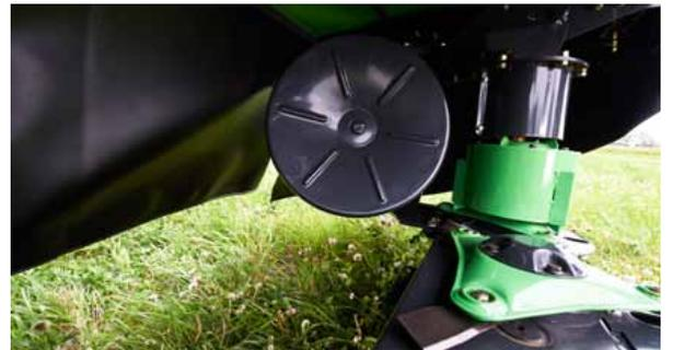
En standard, la faucheuse est équipée d'un disque d'andainage de chaque côté pour réaliser des andains de 2,40m.
