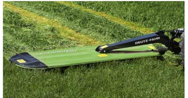
L'articulation pendulaire permet une adaptation rapide et précise aux différents dénivelés du sol.
