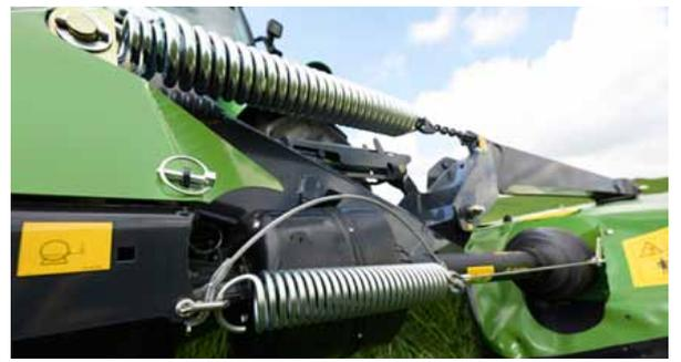
Le ressort de grand diamètre assure une excellente flottaison de l'ensemble de la faucheuse.
