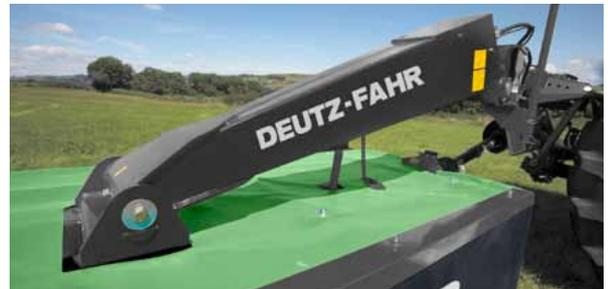
La suspension pendulaire permet une répartition uniforme de part et d'autre de la faucheuse.
