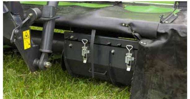
La largeur des andains est facilement réglable en déverrouillant et déplaçant latéralement les tôles d'andainage.
