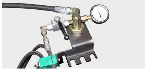
Réglage hydraulique de la pression au sol (DiscMaster 432H et 436H).
