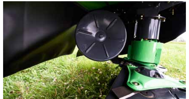
Die Maschine ist serienmäßig mit zwei Schwadscheiben ausgestattet. Sie ermöglichen Schwadbreiten von ca. 2,40 m.
