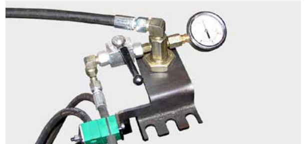
Hydropneumatische Bodendruckentlastung und perfekte Boden Anpassung.
