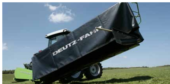
Vorgewendeaushub über einen Hydraulikzylinder.
