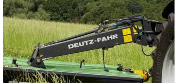
Am Vorgewende wird das Mähwerk über einen Hydraulikzylinder ausgehoben.
