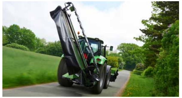
Vertikale Transportposition von bis zu 125° für eine optimale Gewichtsverteilung.
