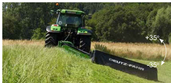
Durch diese Anhängung kann das Mähwerk sich sehr gut Böschungswinkeln anpassen.
