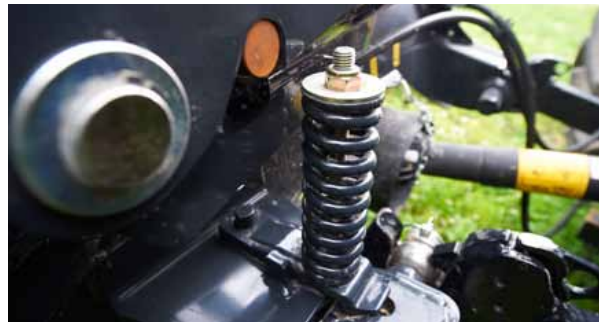
Trifft das Mähwerk auf ein Hindernis, weicht es nach hinten und gleichzeitig nach oben aus.
