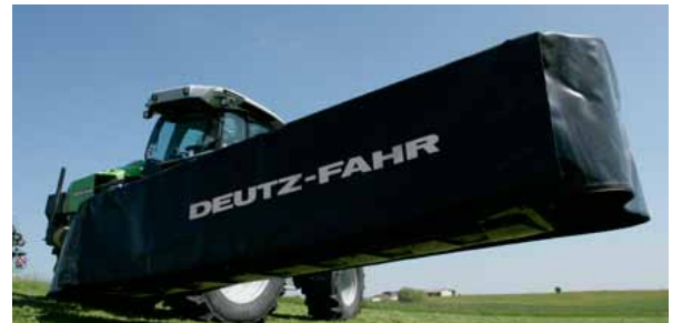
Hohe Bodenfreiheit beim Wenden auf dem Vorgewende.
