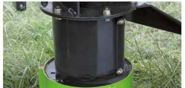
Direktantrieb vom Getriebe zur ersten Scheibe für effiziente Kraftübertragung.
