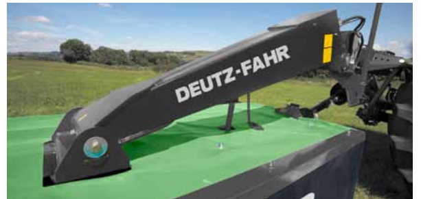
Die mittige Aufhängung des Mähbalkens sorgt für eine perfekte Boden Anpassung.
