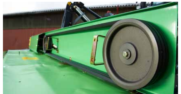
Durch Wechseln der Riemenscheiben kann das DiscMaster 332F mit 750 U/min gefahren werden.
