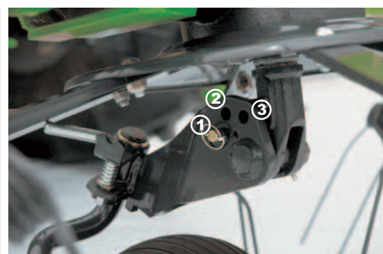
Werkzeuglose Streuwinkelverstellung in drei Stufen.
