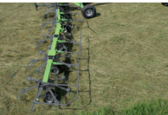
CondiMaster 14042: Serienmäßig mit hydraulischer Grenzstreueinrichtung.
