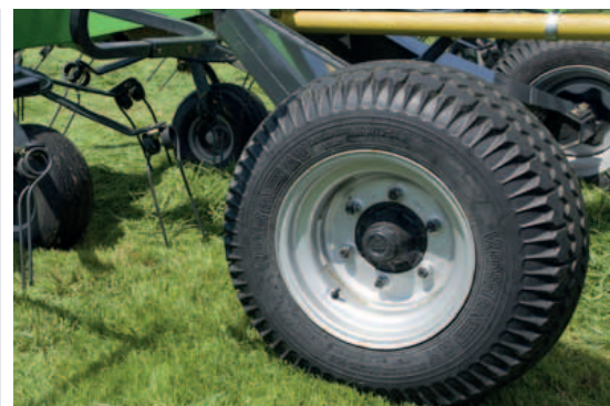
Serienmäßig 18.5" Bereifung unter der Mittelmaschine für den CondiMaster 9021 und 9041.
