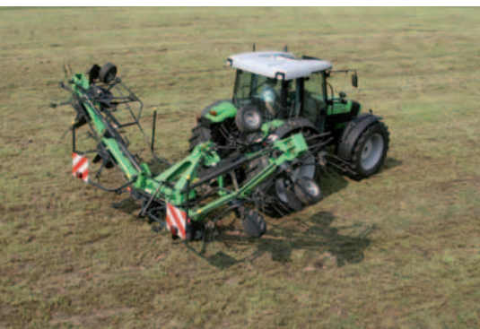
Die Klappung erfolgt hydraulisch, ebenso wie die Transportverriegelung.
