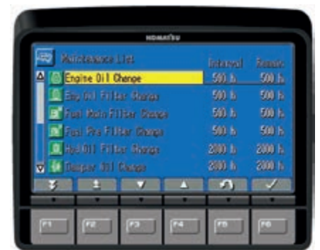
Monitor de mantenimiento
