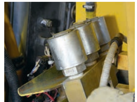
Los respiraderos con filtro externo facilitan las operaciones de control y de limpieza (opcionales)
