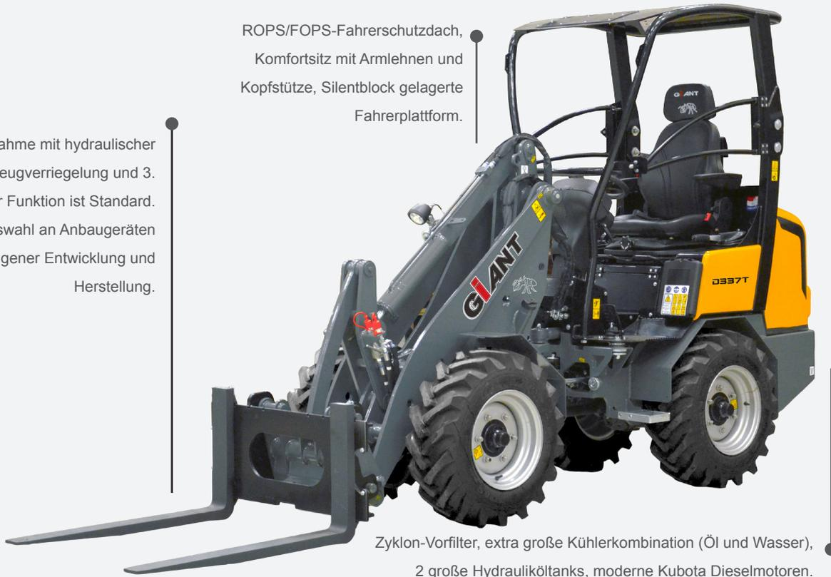
Zyklon-Vorfilter, extra große Kühlerkombination (Öl und Wasser), 2 große Hydrauliköltanks, moderne Kubota Dieselmotoren.
