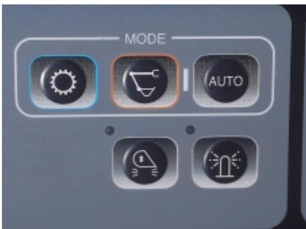
Der **Auto-Modus** der neuen CX130 vereinfacht das Fahren der Maschine erheblich, denn er ermöglicht eine automatische und permanente Anpassung (ohne Betätigung durch den Fahrer) der Arbeitsweise an die durchzuführende Arbeit.
