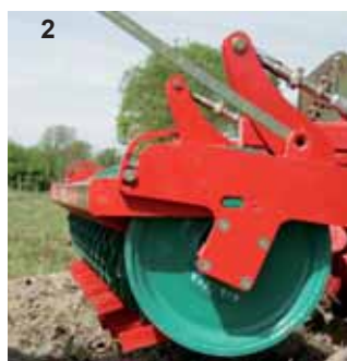
4 posiciones de las cuchillas del Actipack – mayor o menor grado de lecho de siembra
