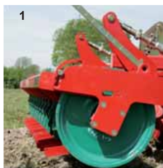
4 posiciones de las cuchillas del Actipack – mayor o menor grado de lecho de siembra
