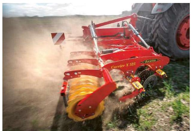
Pracovní hloubka se nastavuje z kabiny traktoru a je tak možné přizpůsobení proměnlivým podmínkám na poli.
