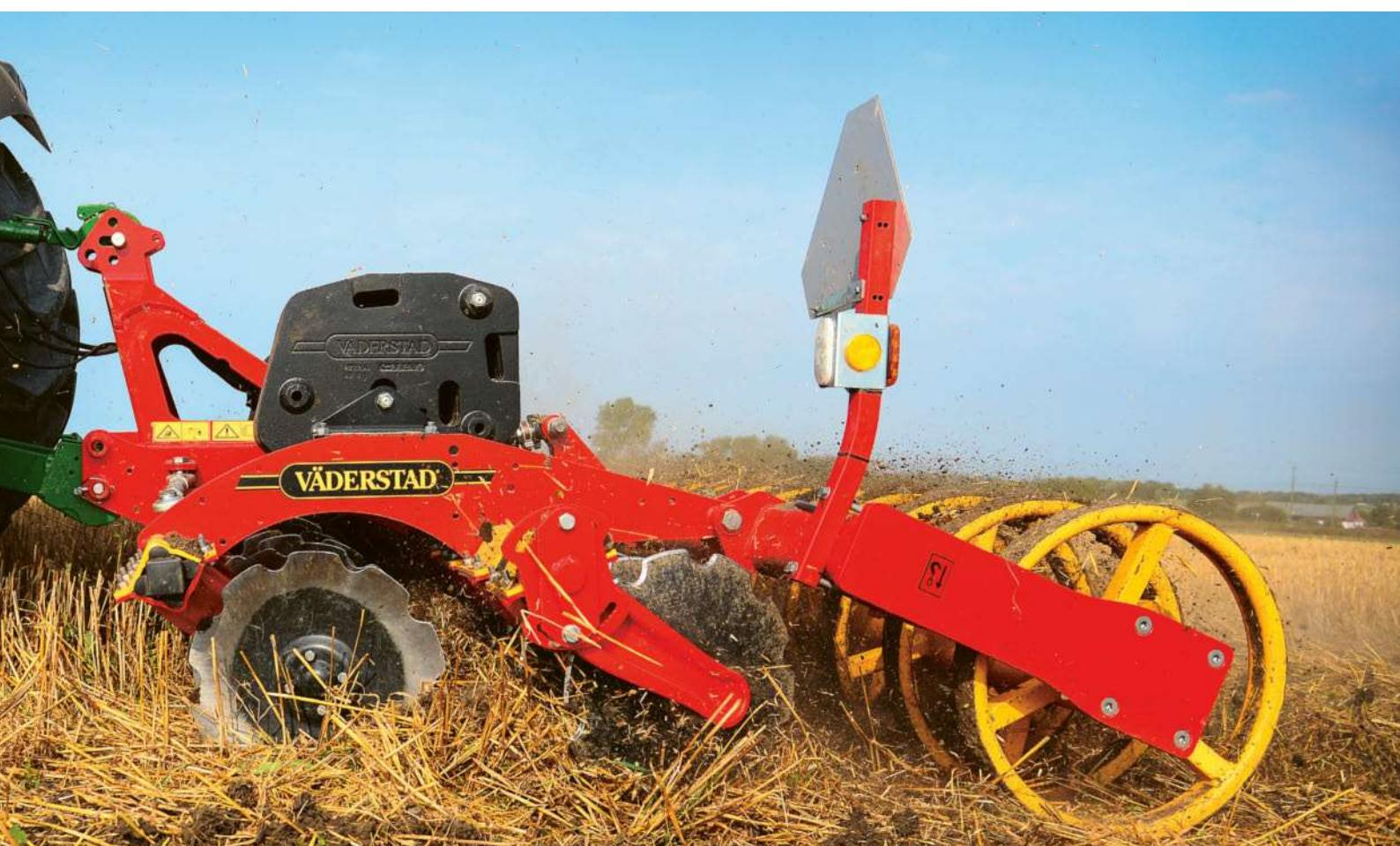
Carrier 300-400 zapravuje rostlinné zbytky a zanechává perfektně urovnáný povrch.
