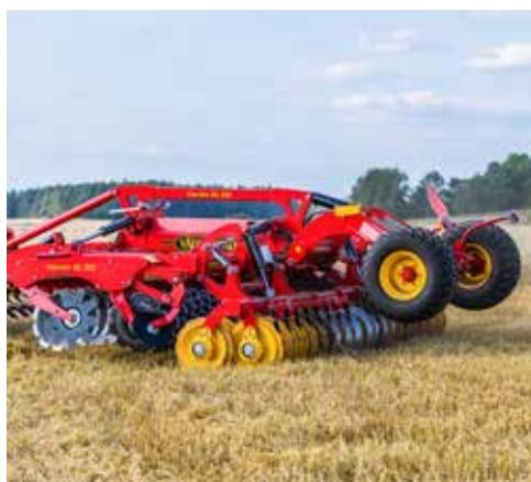
При транспортировке Carrier XL 425-625 между полями боковые секции машины складываются до транспортной ширины 3 м.
