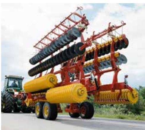
Благодаря уникальной системе складывания Carrier 925-1225 имеет низкий центр тяжести, обладает прекрасной маневренностью при транспортировке и обеспечивает превосходное копирование рельефа.
