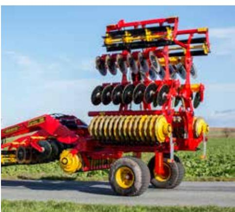
Благодаря уникальной системе складывания Carrier 420-820 имеет низкий центр тяжести, обладает прекрасной маневренностью при транспортировке и обеспечивает превосходное копирование рельефа.
