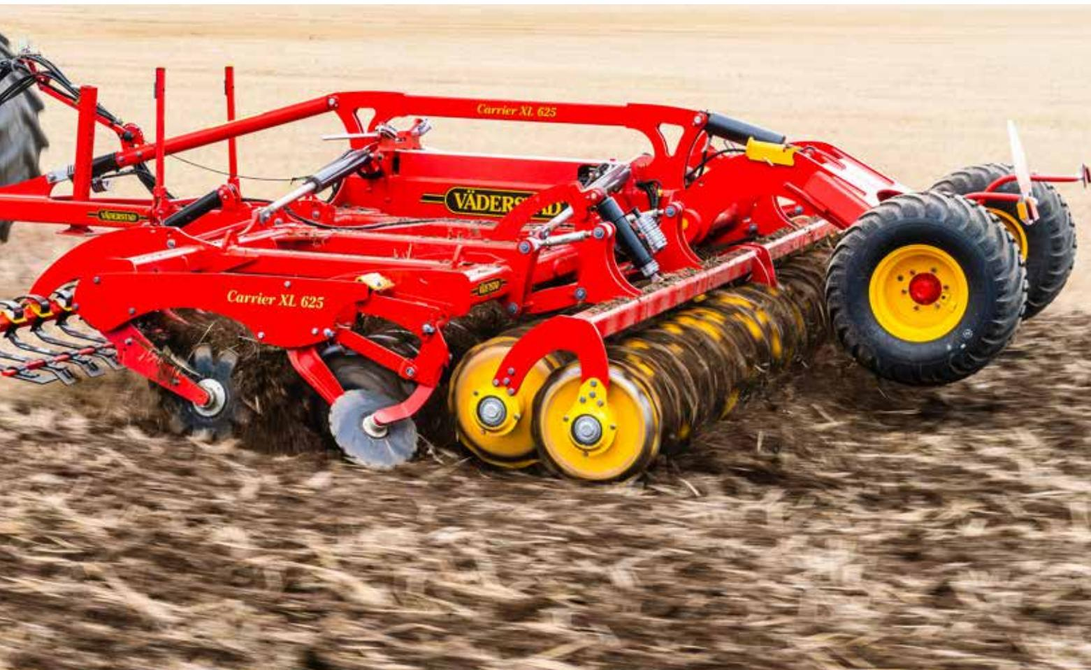
Carrier XL 426-625 может быть оборудован дисками диаметром 510 или 610 мм с регулируемым углом атаки.
