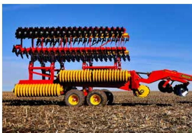
Благодаря уникальной системе складывания Carrier XL 925-1225 имеет низкий центр тяжести, обладает прекрасной маневренностью при транспортировке и обеспечивает превосходное копирование рельефа.
