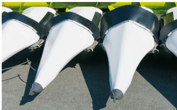
В стандартной комплектации установлены низкие резиновые дефлекторы початков, опционально доступна их высокая версия.
