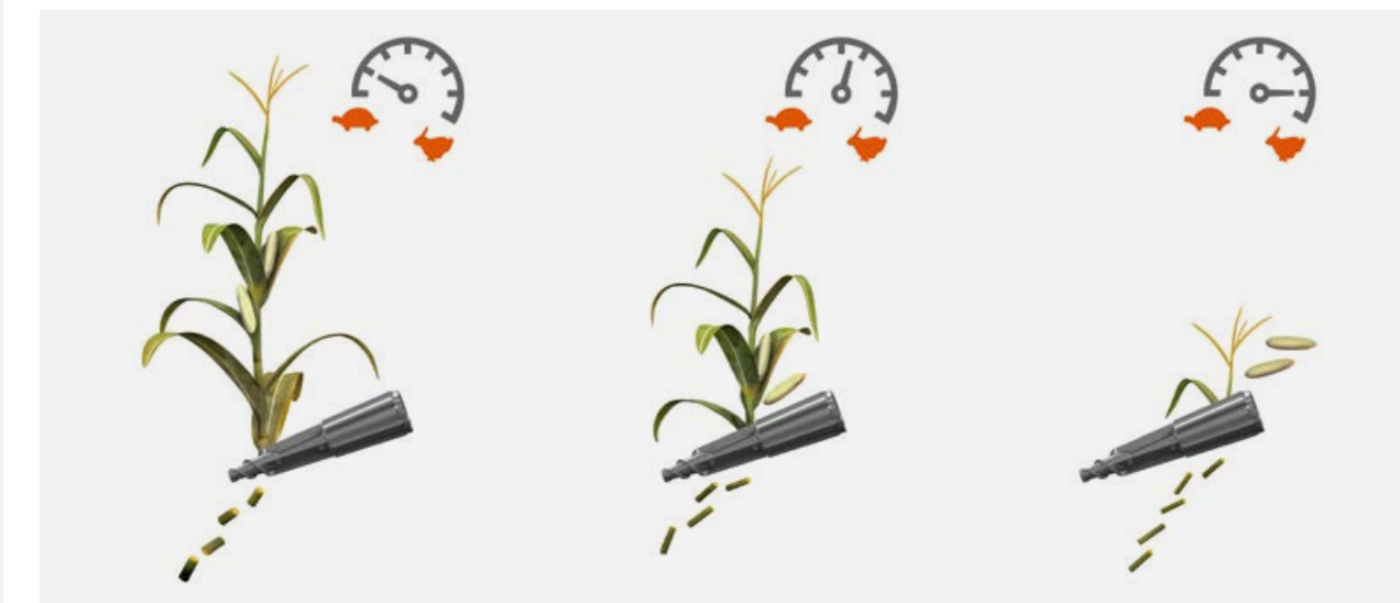
Принцип работы конических початкоотделительных вальцов
