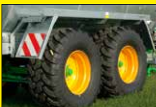
Guardabarros sobre eje doble SIN encastramiento de las ruedas
