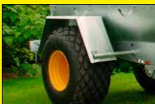
Guardabarros sobre eje simple SIN encastramiento de las ruedas
