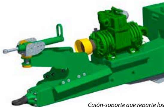
Cajón-soporte que reparte los esfuerzos sobre una gran parte de la lanza
