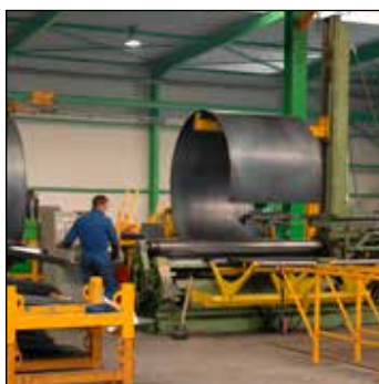
Curvado de la chapa (curvadora con mando digital)
