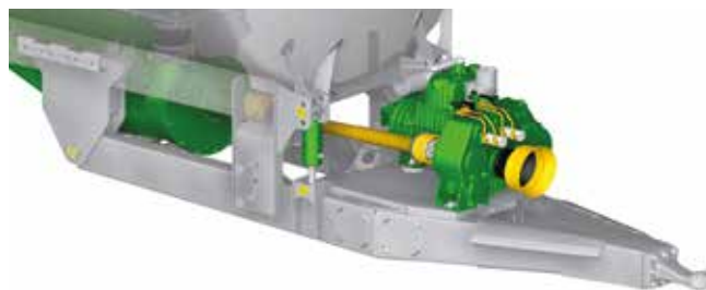
Accionamiento mecánico vía caja de las 2 bombas
