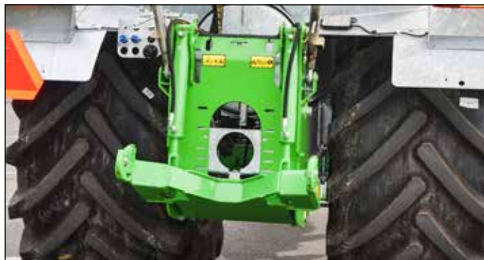
Elevador L600 sobre COBRA (fijado por 4 ejes cónicos para hacer de éste un conjunto robusto)
