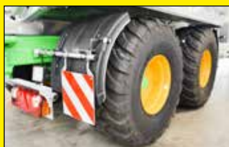
Kotflügel auf Vacu-CARGO mit unabhängigen Spritzlappen
