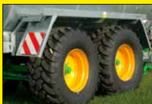
Kotflügel bei Zweiachser OHNE Radkasteneinbau
