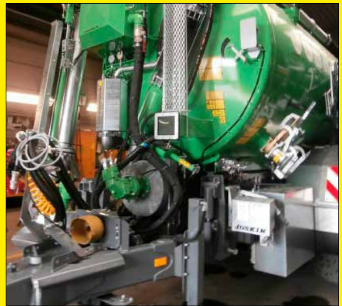
STORM mit hydraulischem Antrieb Power-Pack
