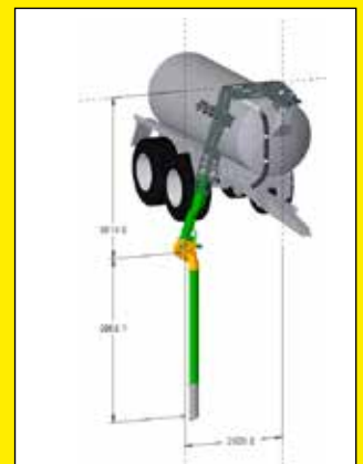
Ansaugrüssel auf vorderem Drehpunkt befestigt, in ausgeklappter Stellung (die Werte variieren je nach der ausgewählten Konfiguration).
