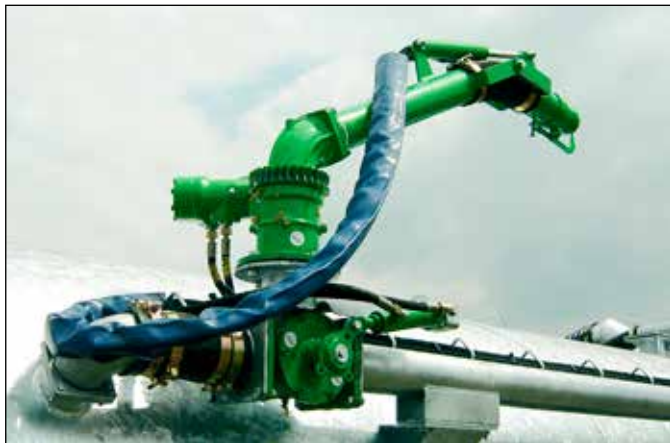
Volumetrisches Rührwerk im Behälter: hydraulischer Dreiwegeschieber
