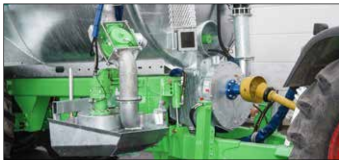
DUAL-STORM mit mechanischem Antrieb der Verdrängungspumpe
