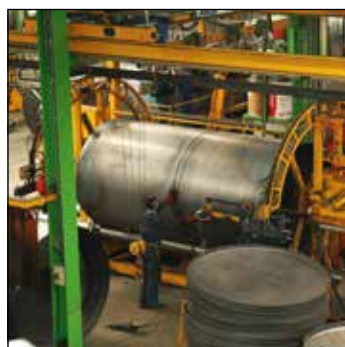
Zusammensetzen der Bögen und Deckel
