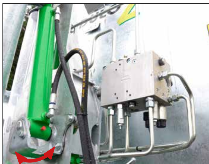
Um die Seite zu wechseln, soll die Zylinderbasis von rechts nach links bewegt werden.
