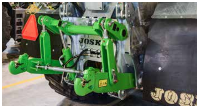
Integriertes Lift-Hubwerk auf VOLUMETRA Behälter
