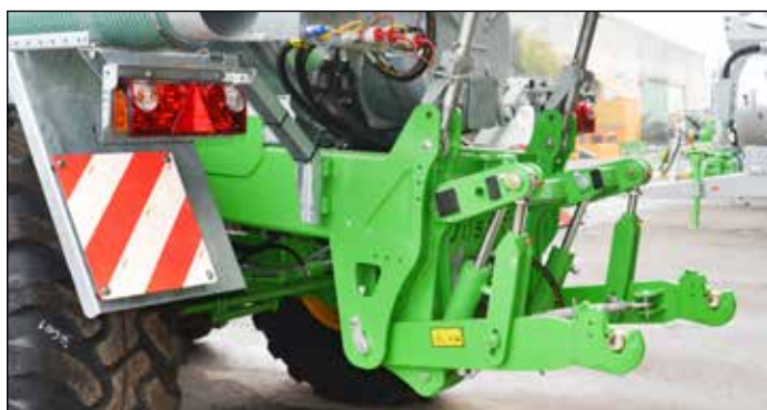
Das integrierte Lift-Hubwerk (völlig im Fahrgestell integriertes Hubwerk) auf QUADRA, X-TREM, TETRAX, VOLUMETRA und EUROLINER
