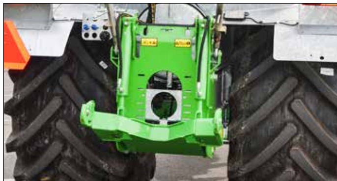
Das schmale Hubwerk auf COBRA (durch 4 konische Bolzen befestigt, für mehr Robustheit)
