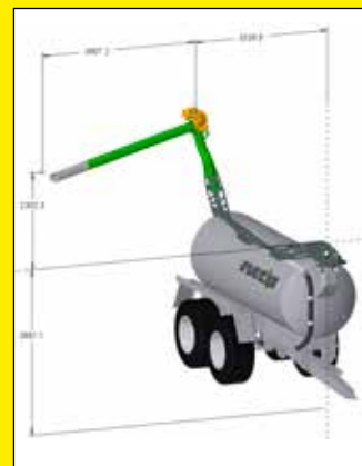
Ansaugrüssel auf vorderem Drehpunkt befestigt, in ausgeklappter Stellung (die Werte variieren je nach der ausgewählten Konfiguration).
