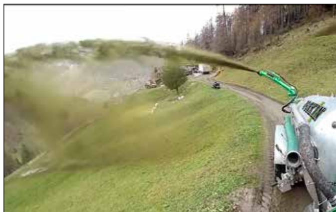
Senkrechte Ausrichtung der Weitwurfdüse durch Hydraulikzylinder (optional).
