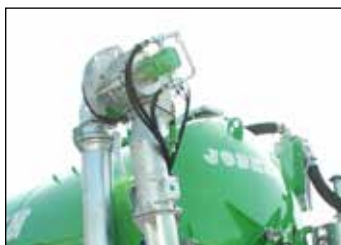
Turbofüller auf gelenkigem seitlichem Ansaugarm
