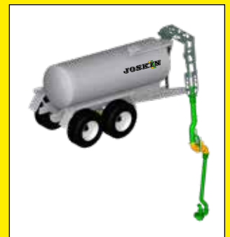
Vorderer Ansaugrüssel mit eingetauchtem Turbofüller
