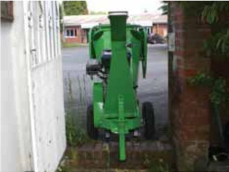
Mit einer Breite von nur 76 cm erlaubt die kompakte Bauweise des CS 100 den Einsatz in beengten Räumen, in die normale Häcksler nicht gelangen würden. Die Möglichkeit des Vor-Ort-Häckselns reduziert die Zeit, die man ansonsten für das Vorab-Zerkleinern und Heranholen des Materials benötigt.
