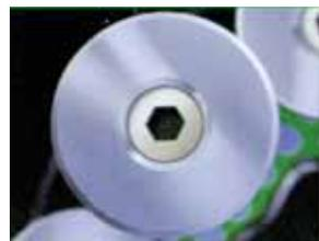
Durch Lockern des Befestigungsbolzens können die Scheibenklingen in beide Richtungen gedreht werden. Sollte die Klinge durch das Einführen von verunreinigtem Material – wie z.B. Steine oder Nägel – beschädigt werden kann die beschädigte Stelle einfach vom Schneidfeld weggedreht werden.
