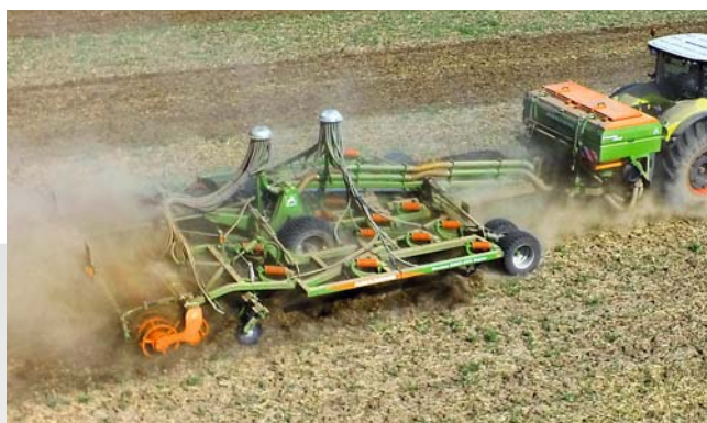
XTender 4200 с культиватором Cenius 6003-2TX и двумя магистральями подачи для внесения удобрений и посевного материала
