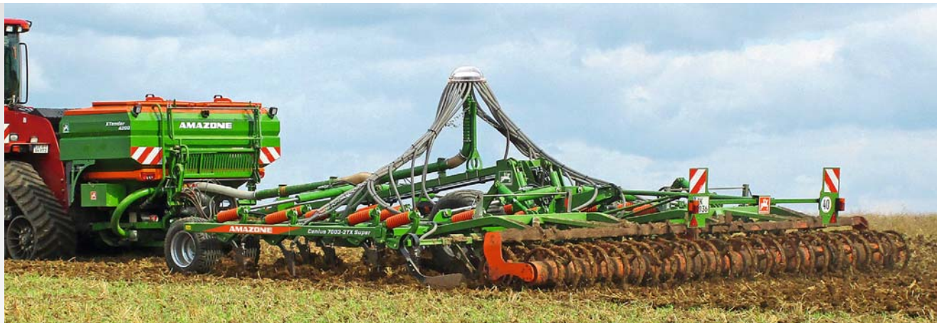
XTender 4200 с культиватором Cenius 6003-2TX и одной магистралью подачи для внесения удобрений
