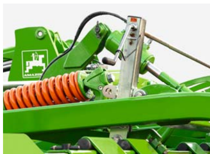
Wrzeciono do centralnej regulacji jednostki równającej w kultywatorze Cenius-2TX
