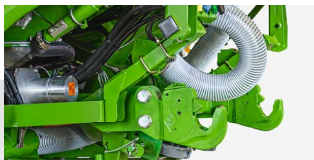
Agregatowanie za pomocą dźwigni dolnych w Cenius-2TX
