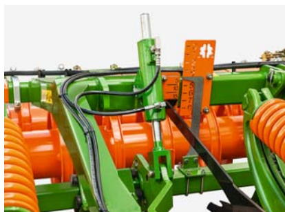
Siłownik do regulacji głębokości roboczej zespołu równającego
