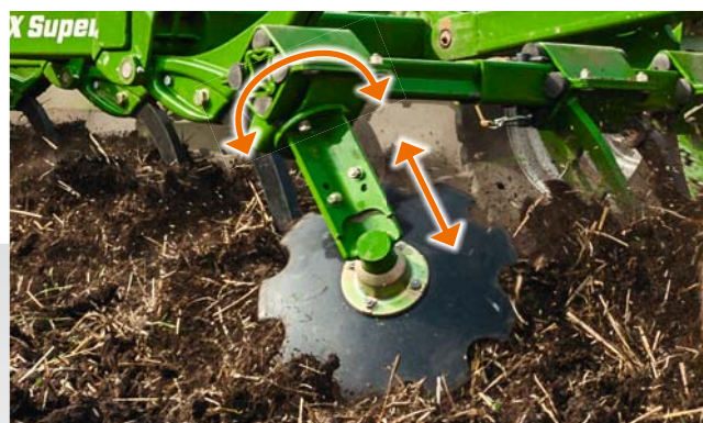
Element boczny – z regulowaną niezależnie wysokością i nachyleniem
