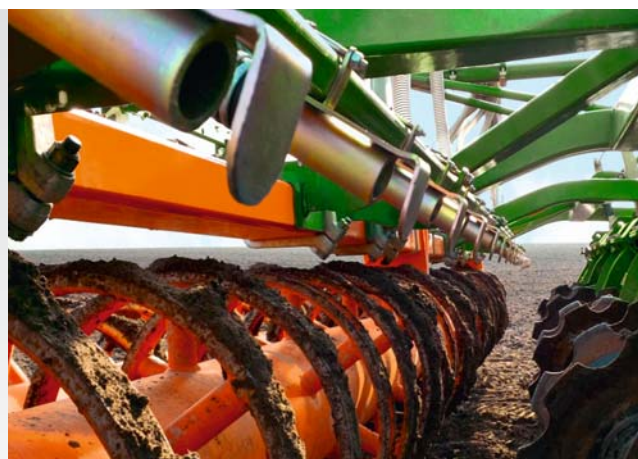
Talerz odbojowy do rozpraszania materiału siewnego
