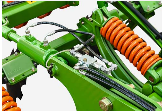
Siłownik do regulacji głębokości pola zębów
