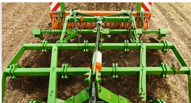
3-belkowa konstrukcja ramy Cenius 3003 Special
