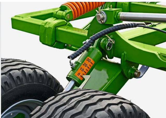
Skala hydraulicznej regulacji głębokości roboczej pola zębów
