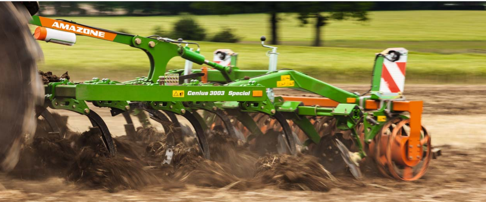
Cenius 3003 Special mit C-Mix-Special-Zinken
