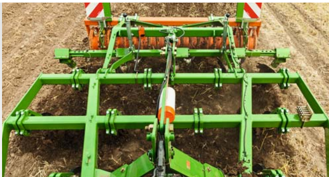
3-balkiger Rahmenaufbau des Cenius 3003 Special
