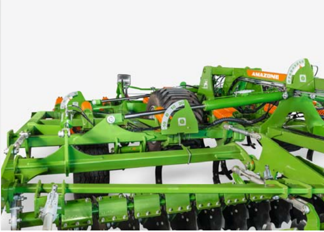
Arbeitstiefenanzeigen der drei Werkzeugeinheiten
