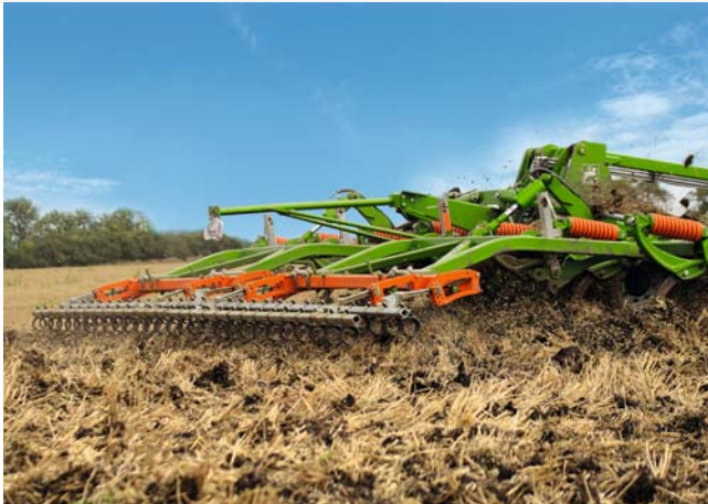
Doppelstriegel bei der flachen Bearbeitung
