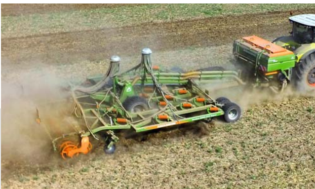
XTender 4200 mit Cenius 6003-2TX und zwei Förderstrecken zur Ausbringung von Dünger und Saatgut
