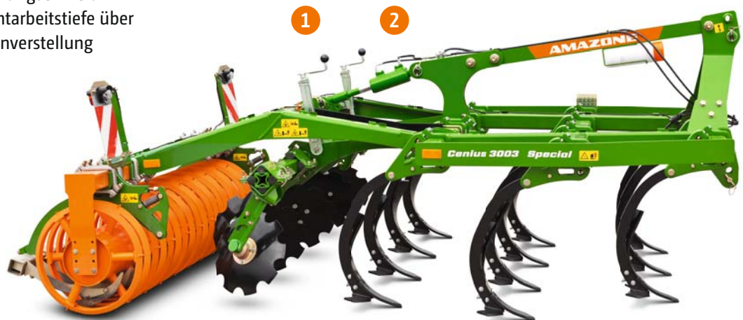
Cenius Special: C-Mix-Zinken mit Scherbolzen-Überlastsicherung und Winkelprofilwalze
