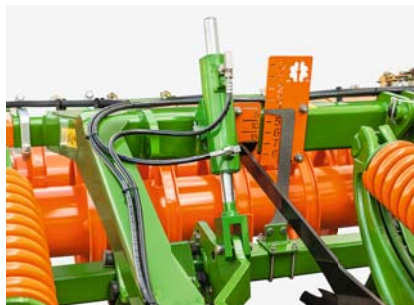
Zylinder zur Tiefeneinstellung der Einebnungseinheit
