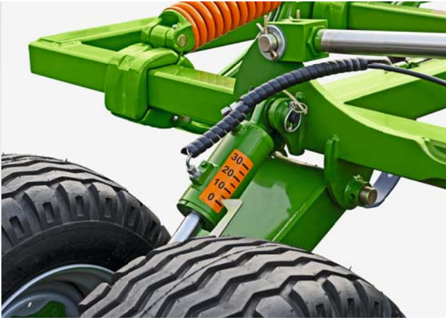
Skala der hydraulischen Arbeitstiefenverstellung des Zinkenfeldes
