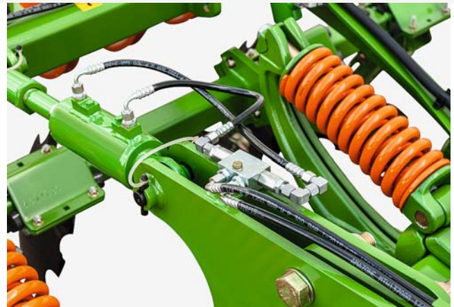
Zylinder zur Tiefenverstellung des Zinkenfeldes
