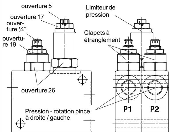
Le limiteur de pression est réglé sur une valeur fixe de 220 bar (CC 1700), 170 bar (CC 2500, CC 3300) pour la fonction "Rotation de la pince".
