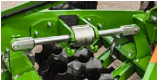
✔ Arbeitstiefeneinstellung durch Distanzelemente – hier flache Arbeitstiefe
