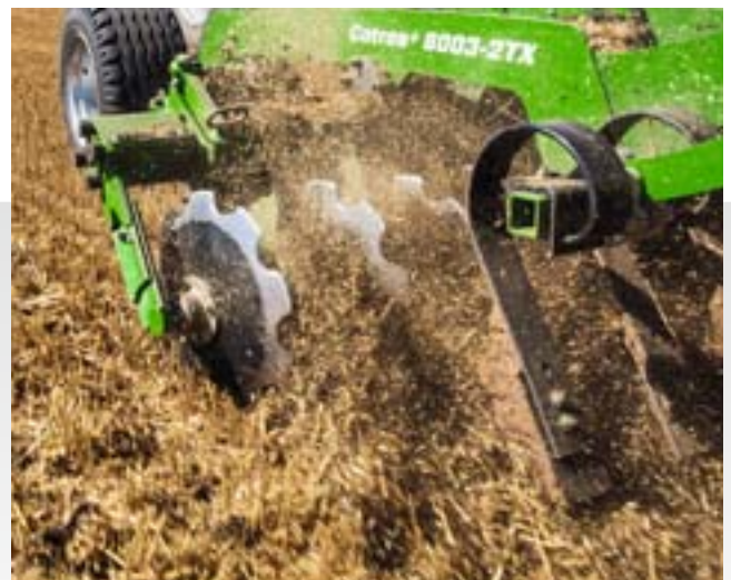
Crushboard mit hydraulischer Tiefenverstellung und übersichtlicher Skala
