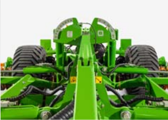
Die Arbeitstiefenanzeige des Crushboards (links) und des Scheibenfelds (rechts)
