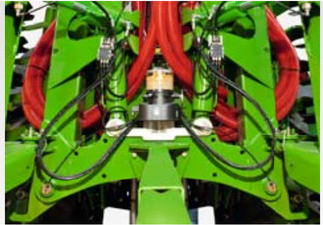
Elektrisches Zentralschmiersystem an der Catros mit pro-Paket
