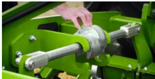
✔ Arbeitstiefeneinstellung durch Distanzelemente – hier mittlere Arbeitstiefe
