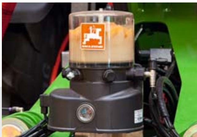
Pumpe mit Vorratsbehälter
