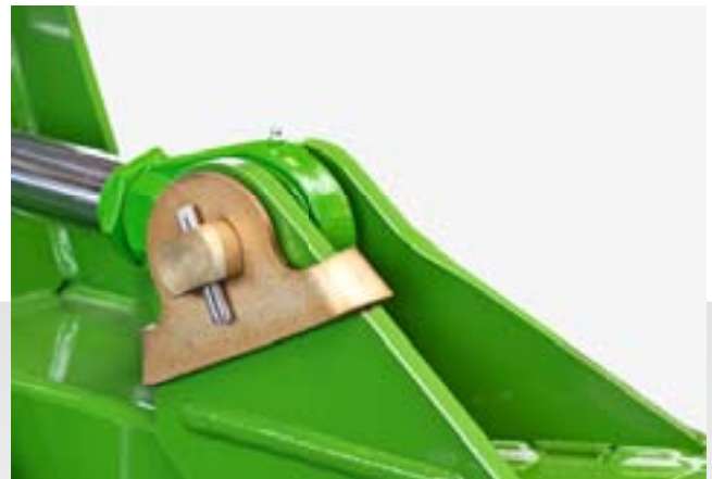
Hochfeste Bolzen und Verdrehsicherungen im pro-Paket
