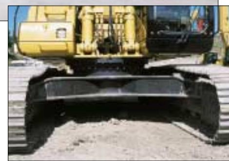
**Рамы опорных катков.** Изготовленные штамповкой и роботизированной сваркой рамы опорных катков имеют пятиугольную форму и обладают исключительной прочностью и долговечностью.
