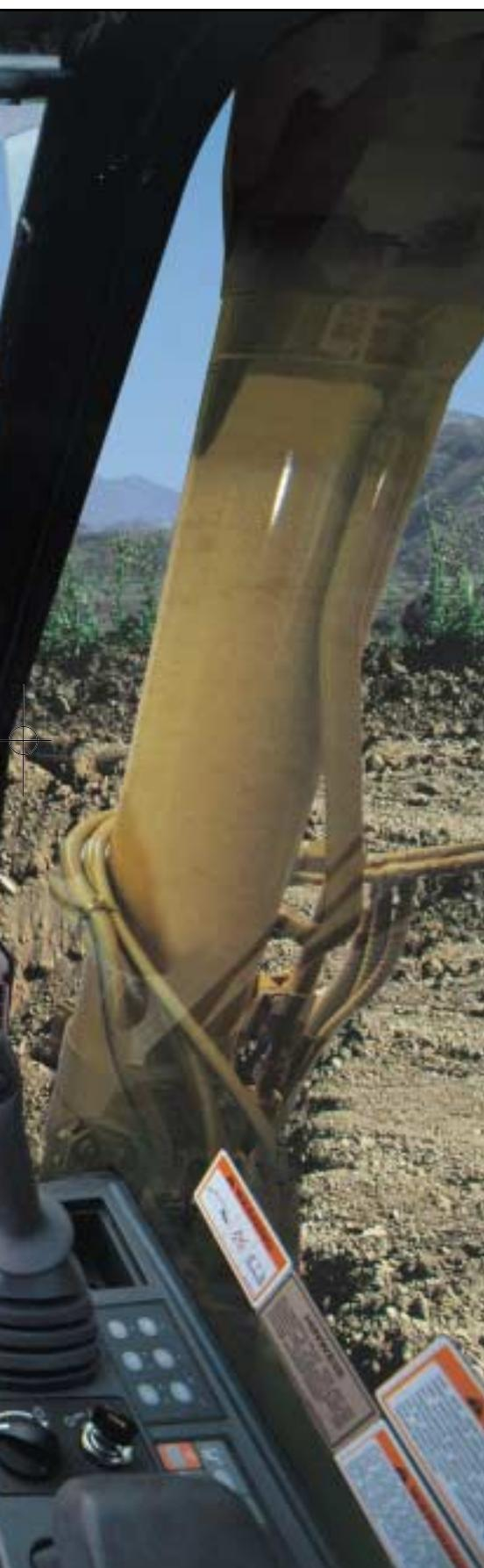
**Рабочее место оператора.** В эскаваторах 322С L кабина оператора полностью шумоизолирована и отличается эргономичным расположением органов управления и удобством их манипуляции, небольшими усилиями на рычагах и педалях, удобной формой и конструкцией сиденья и хорошей вентиляцией.
