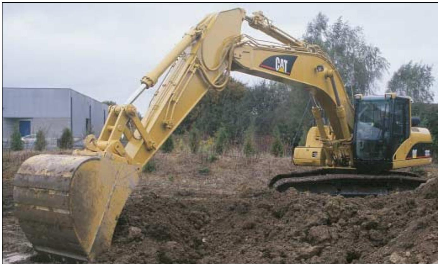
**Стрелы и рукояти.** Рассчитанные на высокие эксплуатационные показатели и длительный срок службы стрелы и рукояти компании Caterpillar представляют собой крупноразмерные сварные конструкции коробчатого сечения с толстыми многослойными участками в зонах наибольших напряжений.
