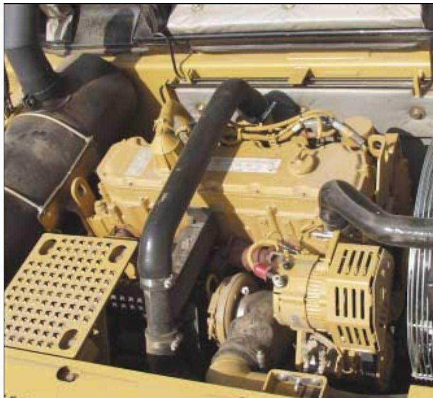
**Высокая мощность.** Двигатель 3126В АТААС развивает полезную мощность 123 кВт (165 л.с.) при номинальной частоте вращения 1800 мин<sup>-1</sup> и отвечает всем современным мировым стандартам на чистоту выброса вредных веществ с выхлопными газами.
