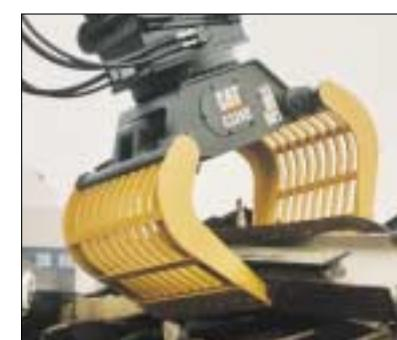
**Устройство быстрой смены навесных орудий с улучшенной фиксацией.** Устройство для быстрой смены навесных орудий с улучшенной фиксацией упрощает и ускоряет смену ковшей и других навесных орудий для различных работ. Устройство монтируется на конце рукояти и позволяет использовать ковши, захваты и другие навесные орудия с небольшой переделкой или без нее.
