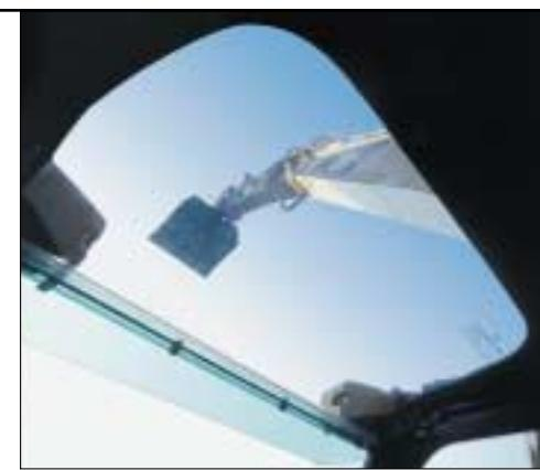
**Верхний обзор.** Уникальное большое окно из поликарбоната обеспечивает очень хорошую видимость ковша или навески в верхней рабочей зоне экскаватора.
