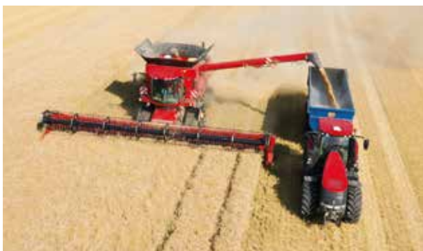
AFS AccuGuide: Guiado basado en GPS y GLONASS para alcanzar la máxima precisión con independencia de las condiciones de cultivo. Niveles de precisión disponibles de hasta 2,5 cm.
