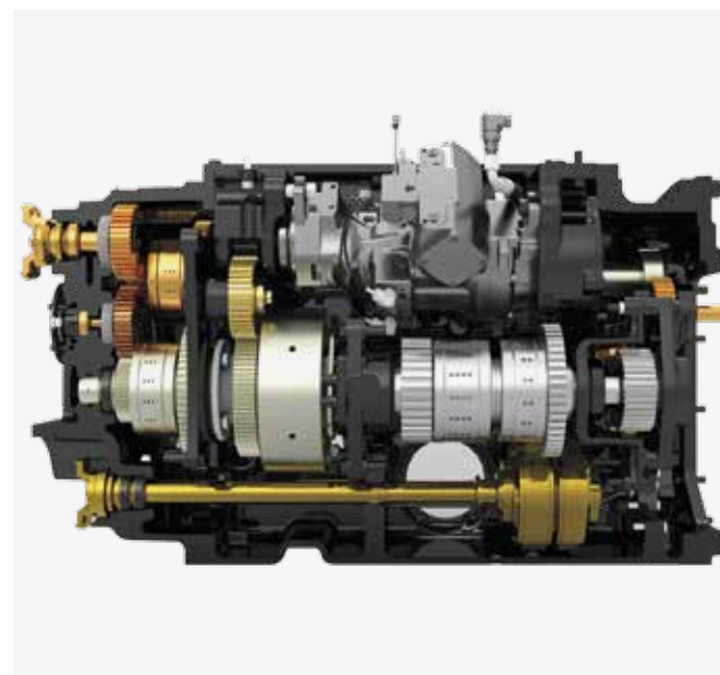
Transmisión CVX - conducción continua de 0 a 50 km/h
