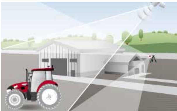
xFill resuelve los vacíos de la señal RTK durante un máximo de 20 minutos.
