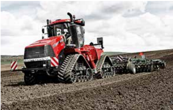
Magnum Rowtrac está basado en el mismo concepto que Quadtrac, con cuatro puntos de contacto al suelo.
