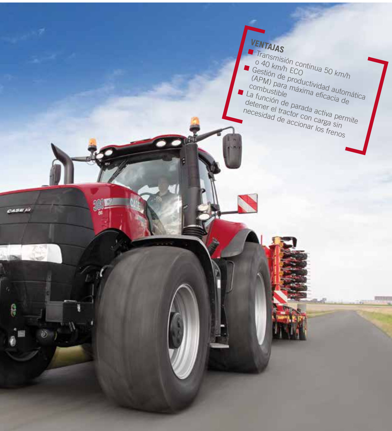
Transmisión CVX - conducción continua de 0 a 50 km/h
