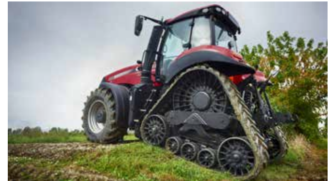
Las ruedas y las orugas se mantienen en contacto con el suelo para alcanzar la máxima tracción.
