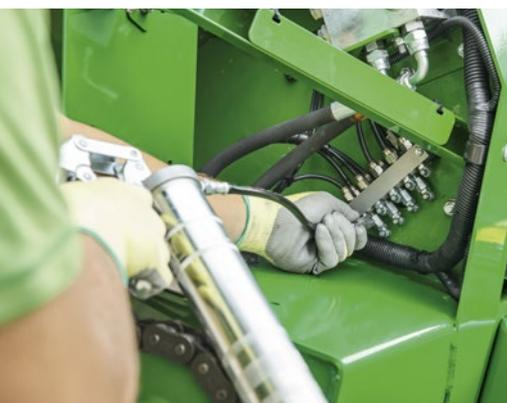
Hemos agrupado todos los puntos de engrase en un sistema de engrase centralizado para facilitar el acceso. El sistema de engrase de cadena automático se incluye de serie.
