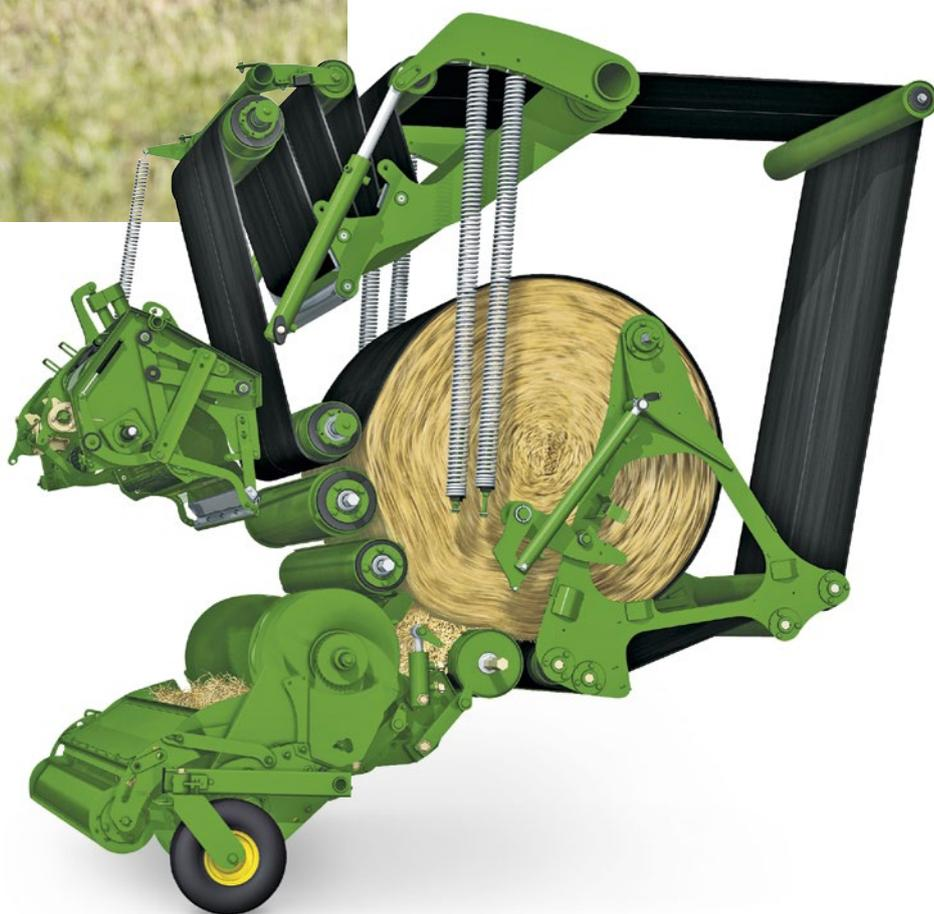
Dos correas anchas de 576 mm proporcionan alta densidad y una cobertura perfecta de la paca en todo tipo de cultivos. Un sistema de seguimiento de las correas de alta eficiencia asegura un perfecto guiado de las correas en cualquier condición. Tres rodillos en la cámara aseguran un perfecto giro de la paca independientemente del contenido de humedad del cultivo.
