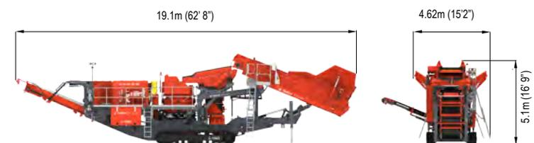
Вес машины: 51 680 кг (113,935 фунтов) без дополнительных приспособлений
