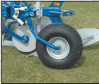
Gecombineerd steun-en transportwiel 10.00 -12. Diameter 710 mm, breedte 264 mm.
