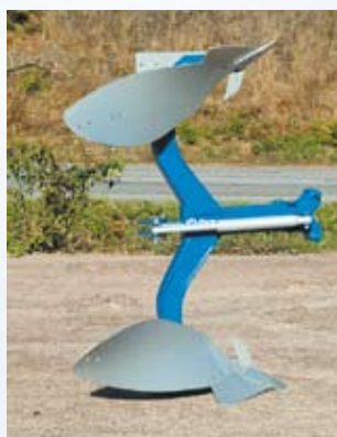
Door de ruime bouw kunnen grote hoeveelheden gewasresten de ploeg passeren.
