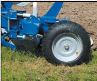
Gecombineerd steun-en transportwiel (10,5 -16) voor Xcelsior en Vari Flex DX modellen. Diameter 755 mm, breedte 275 mm.
