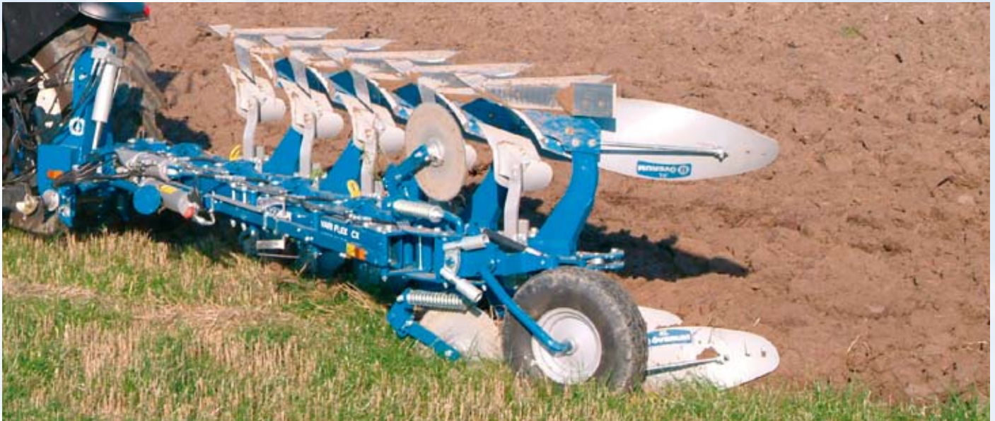
Vari Flex CX 580 H. Hydraulische snijbreedte instelling van 1,5 tot 2,25 m.
