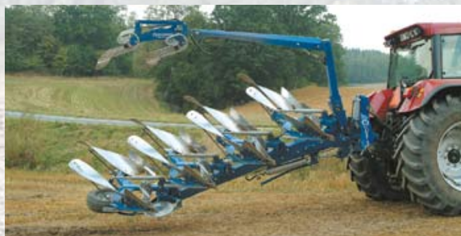
Overrug wentelen vraagt een grotere hefhoogte t.o.v. Overbuik.
