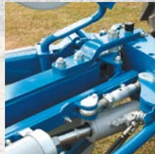
Met de treklijn instelling kunnen alle zijdelingse krachten worden uitgebalanceerd.
