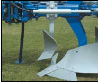
Voorschaar EM. Verwerkt grote hoeveelheden stoppelresten. Werkt het best in combinatie met tipkouter.
