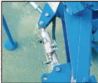
Hydraulische snijbreedteverstelling van het 1 lichaam bij de BX.
