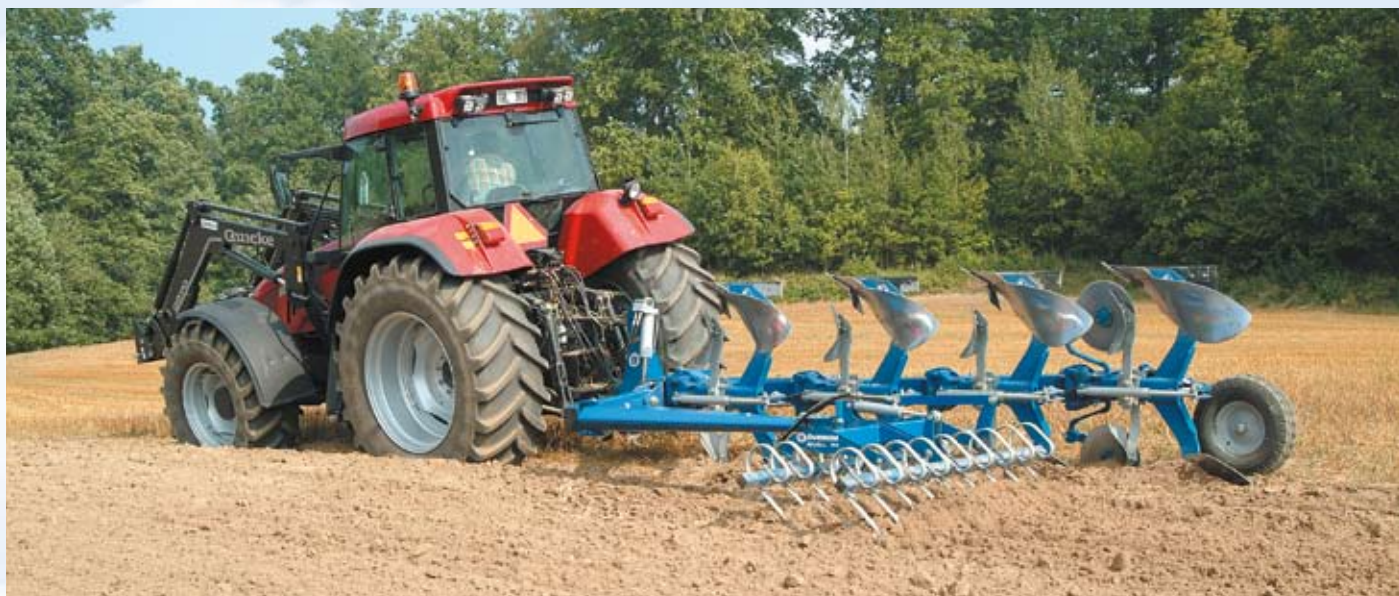
CX 490 H met Nivell snede verdeler. Ploegen en egaliseren in één werkgang.
