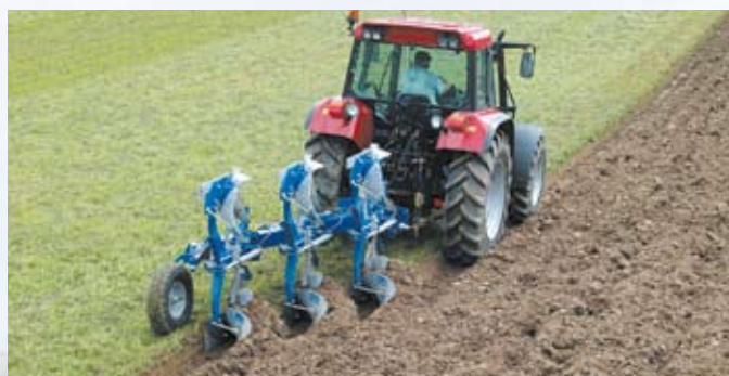
CX 390 H. XL-risters en EG-voorscharen geven een goed ploegresultaat.
