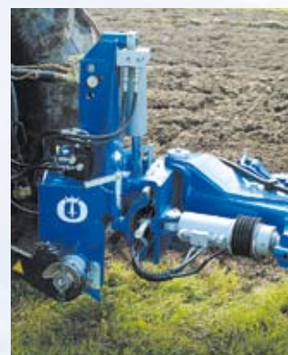
"Heavy Duty" ploegkop met snelkoppelas Cat.3 en inzwenkcilinder.
