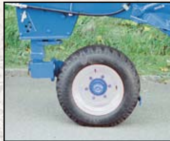
Gecombineerd steun-en transportwiel (10,5 -16) voor Xcelsior DX modellen. Diameter 755 mm, breedte 275 mm.
