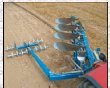
Nivell geïntegreerde snedeverdeler en kluitenbreker voor 3 tot 4 scharen.
