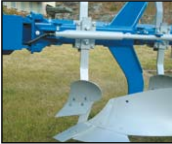
Voorschaar EG. Brede ondiepe werking. Werkt goed met tipkouter en schijfkouter.
