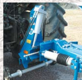
Snelkoppelas voor snelle en veilige aankoppeling.
