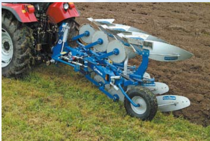
BX 380 H, gemakkelijk te heffen zelfs voor tractoren met een beperkt hefvermogen.
