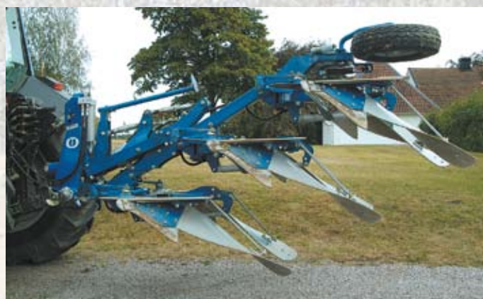
Doordat de ploeg overbuik wentelt, is het zwaartepunt van de ploeg dicht bij de tractor geplaatst waardoor de ploeg makkelijker te heffen is.
