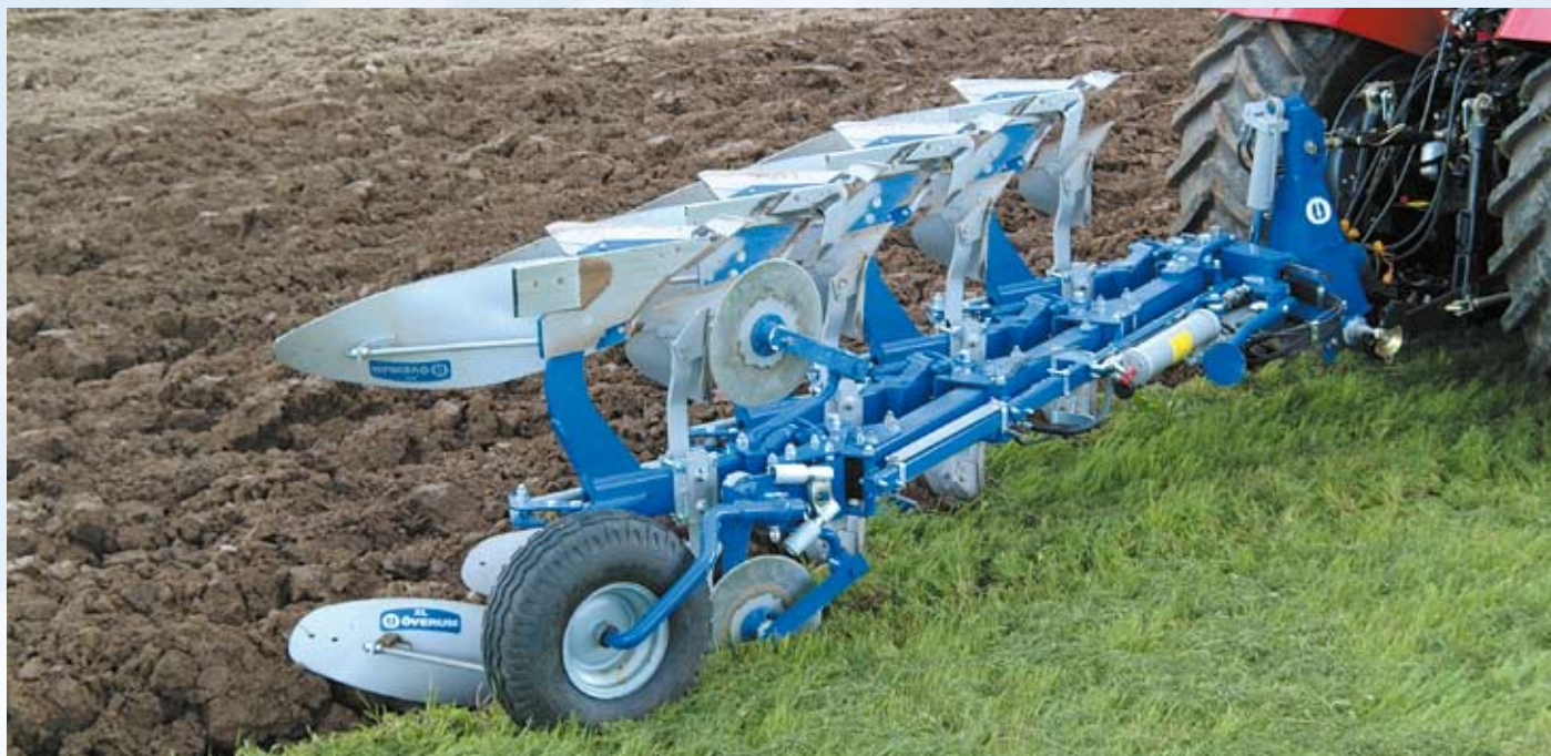
Vari Flex CX 490H met hydraulische snijbreedte verstelling van 12 tot 20 inch.
