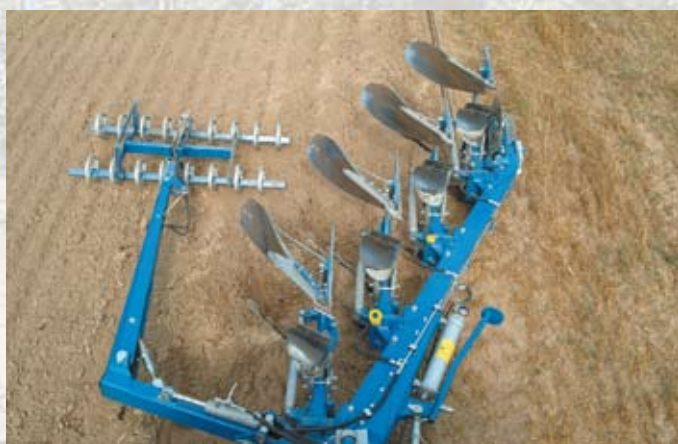
De Nivell-arm is taps toelopen om de grootste krachten in het sterkste punt op te vangen.
