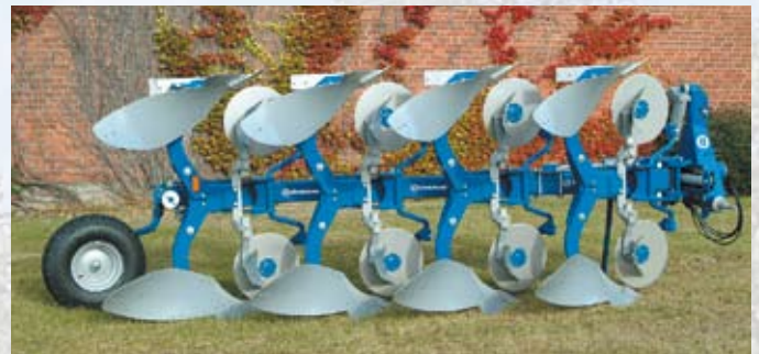
Vari Flex CX 490 F met schijfkouters en EG voorscharen. De ploeglichamen en voorscharen zijn voorzien van breekbouten.
