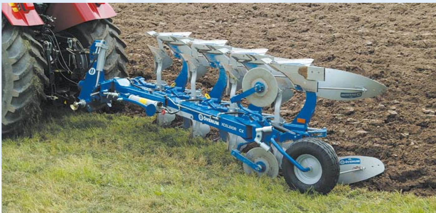
CX 490 H met EM-voorscharen. 90 cm schaarpunt afstand biedt voldoende ruimte voor goede werking van de voorscharen.
