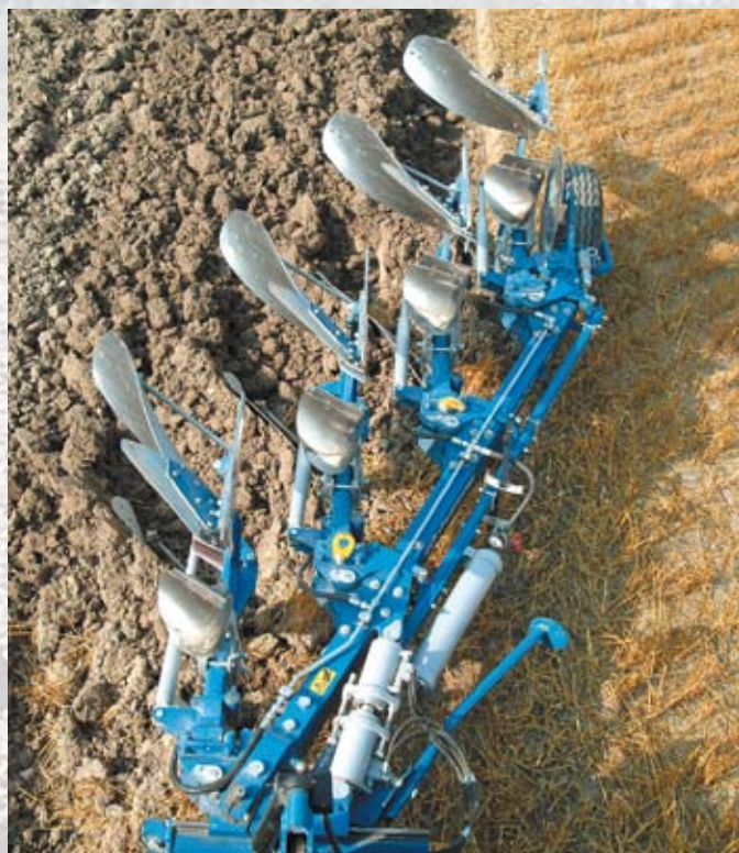
Precisieboring van de bevestigingspunten voor het scharniemechanisme heeft het mogelijk gemaakt om een warmtebehandelde hoofdframe toe te passen.
