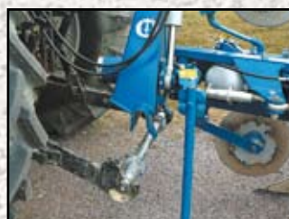
Snelkoppelas voor snelle en veilige aankoppeling.
