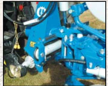
Hydraulische snijbreedteverstelling van het 1 lichaam bij de CX en DX.
