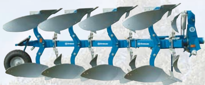
BX 490 F met EM-voorscharen. Ieder ploeglichaam en ankersteel is beveiligd door middel van een breekbout.
