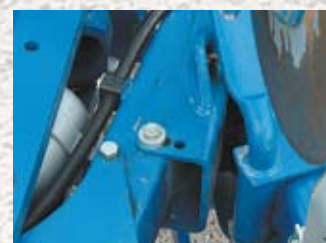
De snijbreedte per lichaam kan versteld worden in drie stappen.
