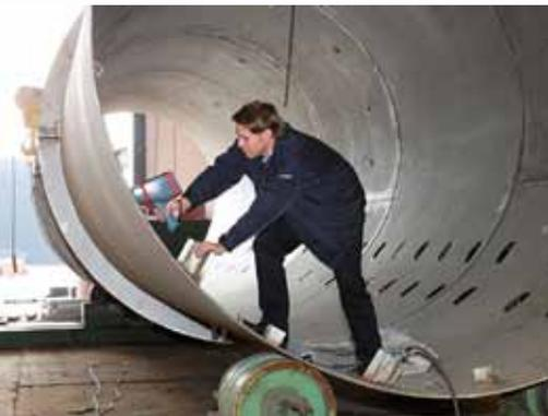
DIESES ENERGIEDISPERSIVE RÖNTGENFLUORESZENZ- (EDRFA) HANDSPEKTROMETER bewältigt sowohl Elementprüfung mit hohem Durchsatz als auch spektrochemische Analysen einer Vielzahl von Materialien – und das unter unterschiedlichsten Bedingungen. Seine bahnbrechende Geschwindigkeit und Präzision, in Verbindung mit seiner einfachen Bedienung, machen das SPECTRO xSORT in vielen Branchen zum perfekten Instrument für die Überwachung der Anlagensicherheit.
