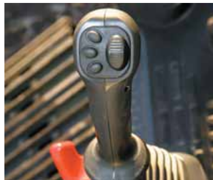
Grävspakar med proportionell kontrollknapp för redskap
