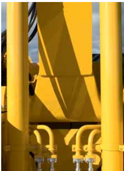
Base da lança em aço fundido
