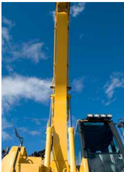
Topo e base da lança de uma peça inteira
