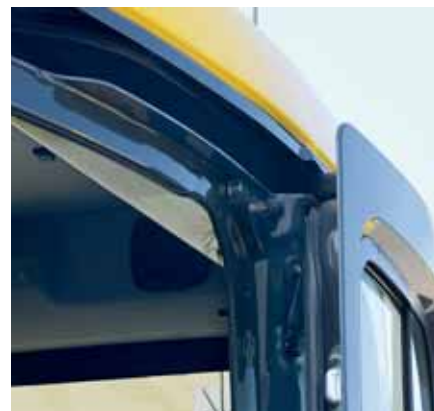
A porta corredeira facilita a entrada em espaços exíguos, ao mesmo tempo que reduz o perigo de ser danificada nas estradas. De salientar que a porta incorpora ainda uma janela também de correr.
