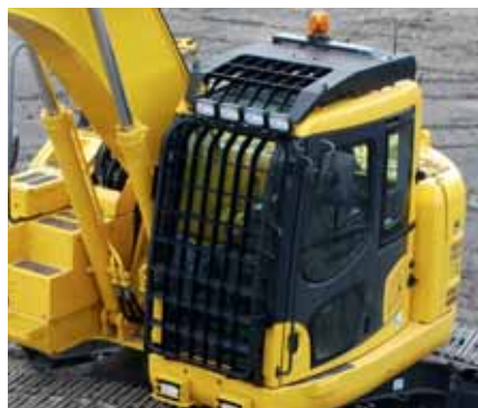
Sistema de Protecção contra Queda de Objectos (FOPS) opcional
