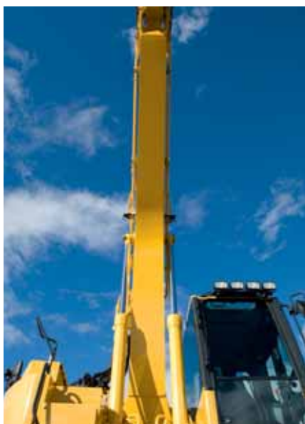
Ściany wysięgnika z jednego kawałka blachy
