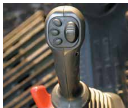
Gravespaker med brytere for proporsjonalstyring av redskaper
