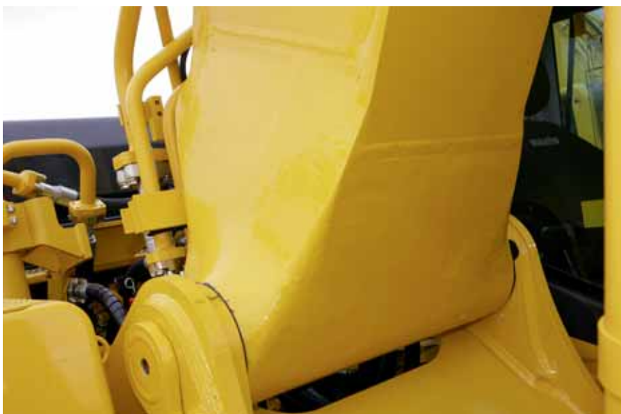
Støpestål i bomfot
