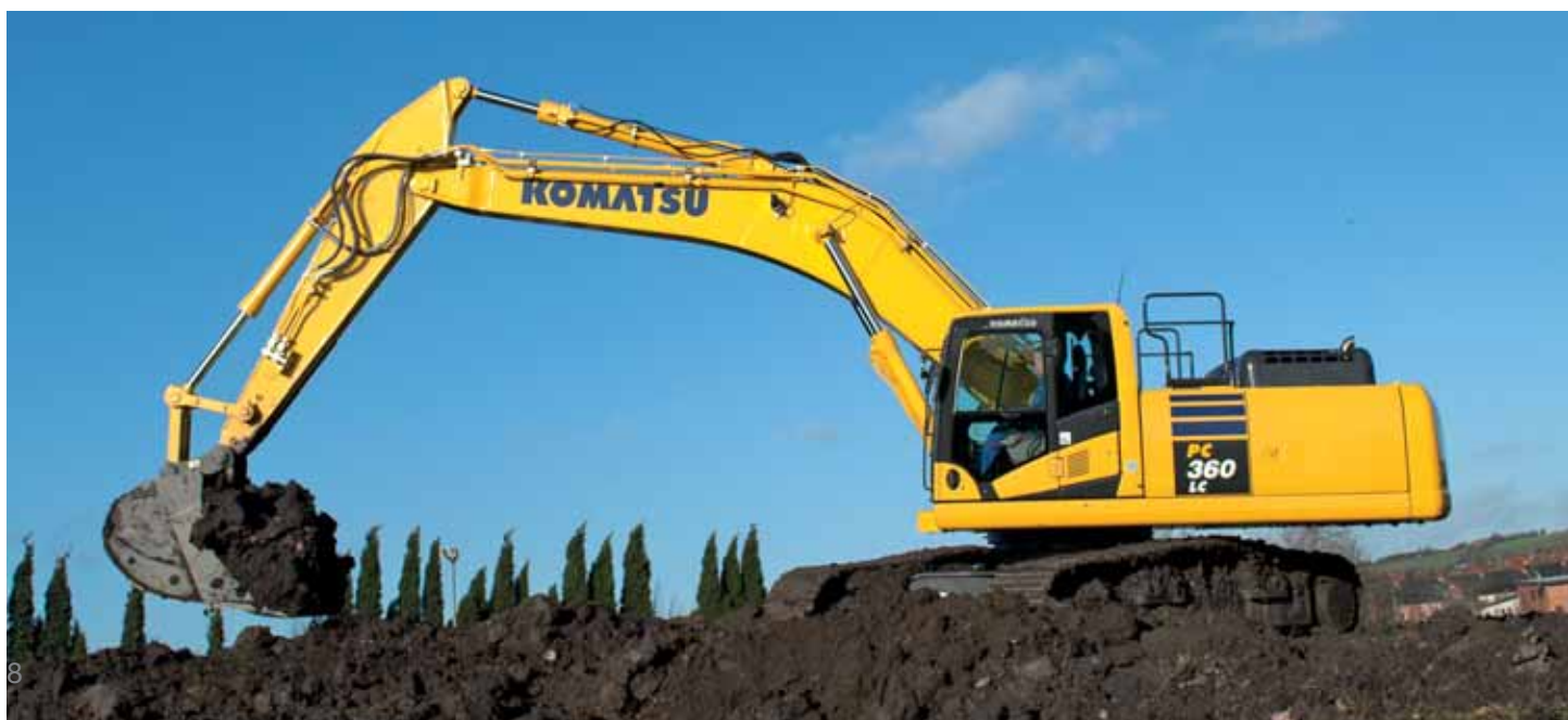
Gravespaker med brytere for proporsjonalstyring av redskaper
