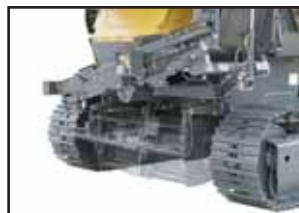
Système d'élévation de la bande transporteuse
