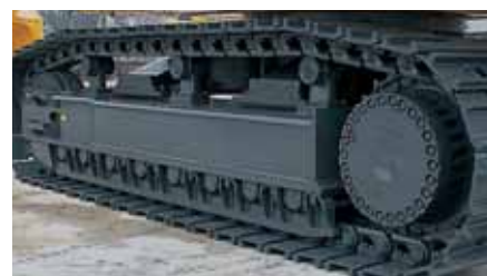
Protección completa de los rodillos del tren de rodaje (opcional)
