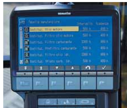
LCD zaslon obvešča o motnjah in intervalih zamenjav
