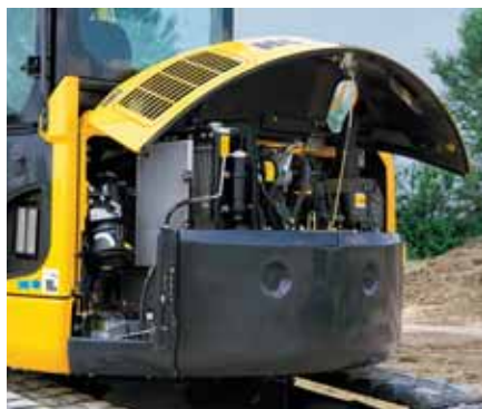
Vse pomembnejše točke vzdrževanja so enostavno dosegljive s tal
