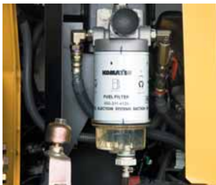
Predfilter za gorivo s separatorjem vode
