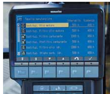
Monitorul LCD ofera informatii cu privire la situatiile anormale si momentele in care trebuie sa se efectueze inlocuirile
