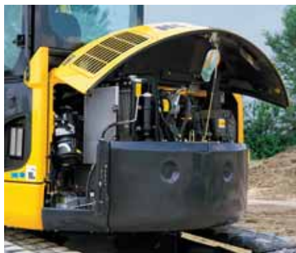
Toate punctele de intretinere sunt usor accesibile de la nivelul solului
