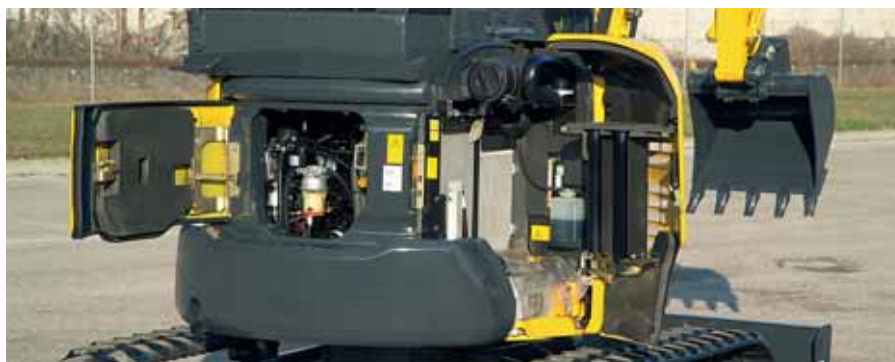
Zadní kapotáže pro rychlou kontrolu motoru, jednoduché prohlídky, čištění chladičů a snadný přístup k akumulátoru.
