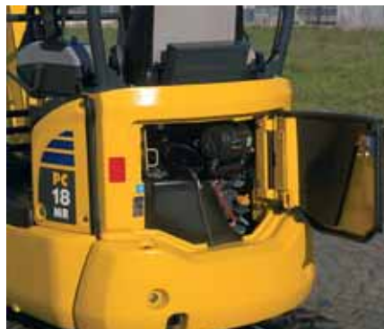
Usa capotaj spate: verificare rapida a motorului si realimentare combustibil.
