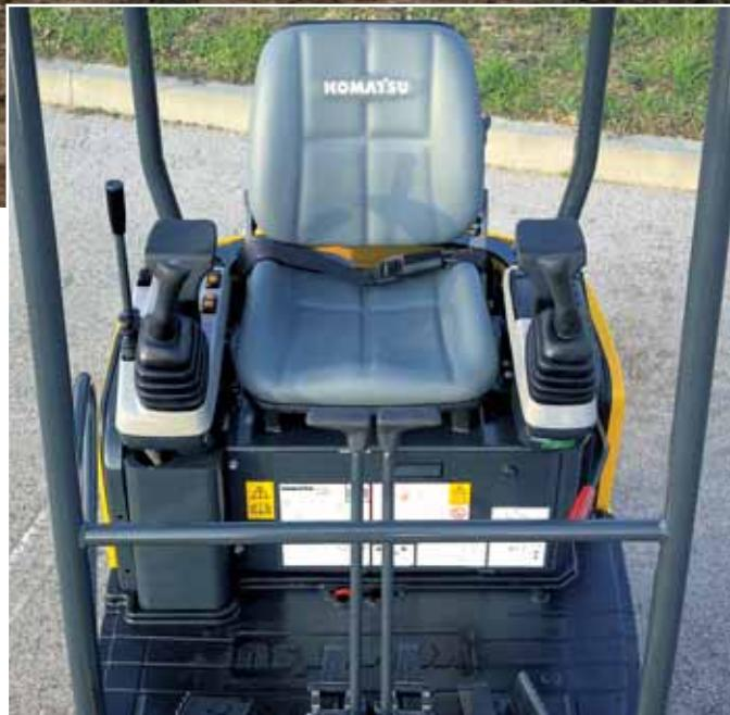
Rularea cu doua viteze se actioneaza printr-un schimbator de pe panoul de comanda. Panoul de comanda permite de asemenea operatorului monitorizarea tuturor functiilor masinii.
