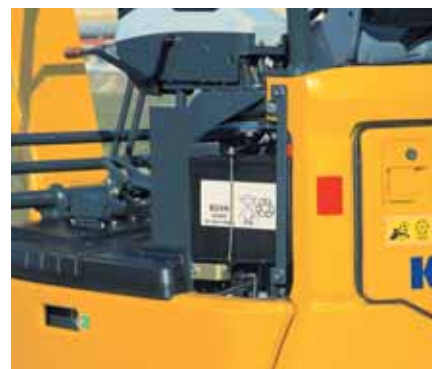
Linker kap: gemakkelijke toegang tot de accu
