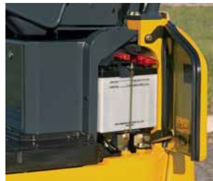
Capó izquierdo: fácil acceso a la batería
