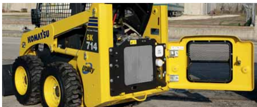
Capó trasero: inspección y limpieza simples de los radiadores
